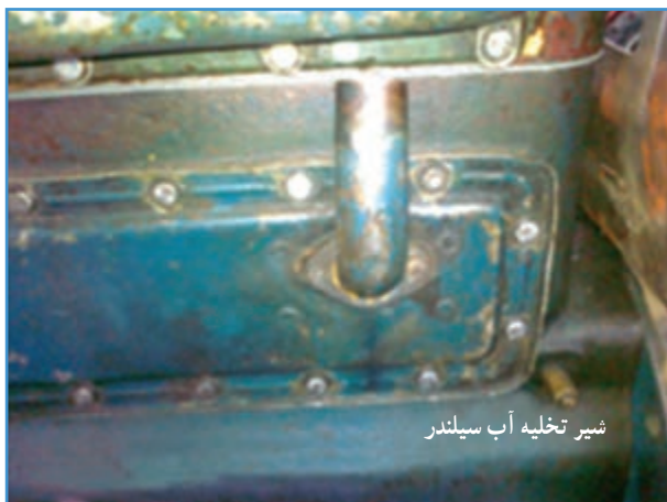
شکل ۸-۳ شیر تخلیه آب سیلندر تراکتور U650
