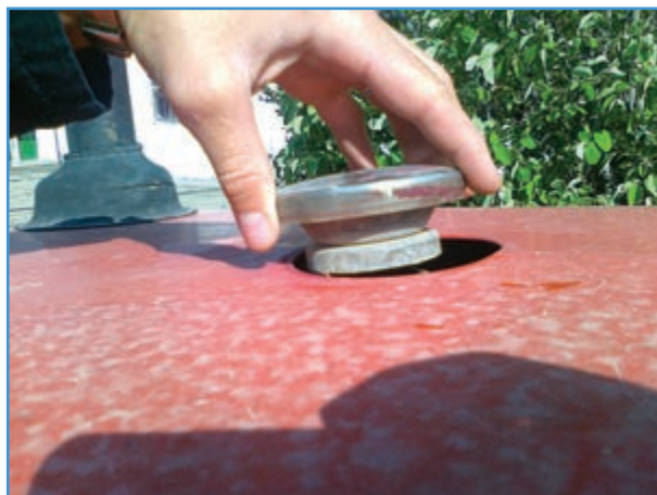
شکل ۷-۳ باز کردن در رادیاتور تراکتور MF285
