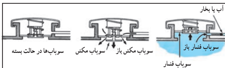
الف) وضعیت سوپاپ‌های در رادیاتور
