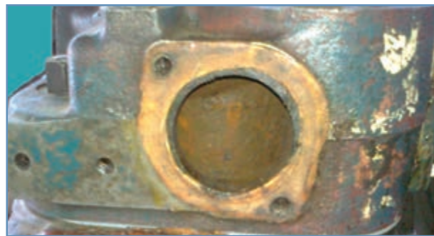
شکل ۲۳-۳ واشر ترموستات قبلی
