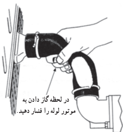
شکل ۲۰-۳ نحوه فشار دادن شیلنگ بالای رادیاتور
