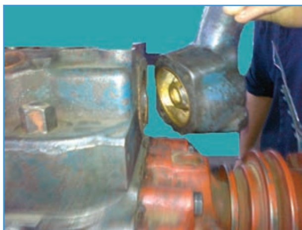
شکل ۲۱-۳ باز برداشتن درپوش ترموستات بعد باز کردن پیچ‌های آن در تراکتور U650M
