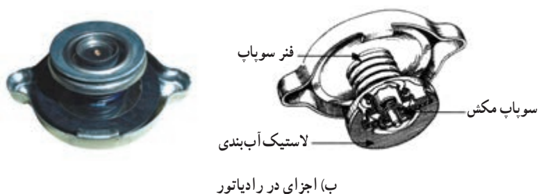
شکل ۳-۵- در رادیاتور و طرز کار سوپاپ‌های آن
