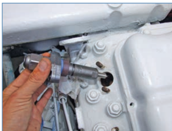
شکل ۲۳-۴ خارج کردن انژکتور
