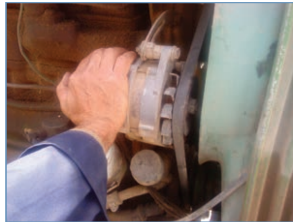
شکل ۳۰-۳ فشار دادن مولد به سمت موتور
