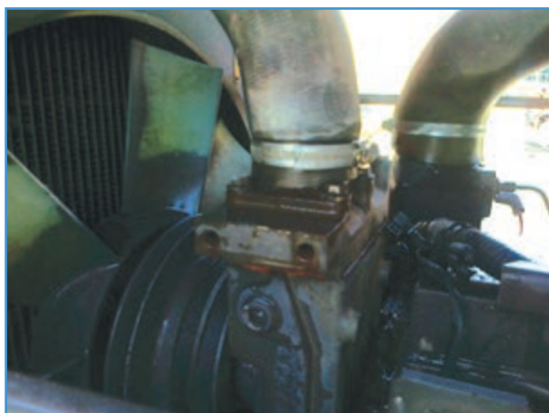
شکل ۱۱-۳- محل بست شیلنگ محفظه ترموستات
