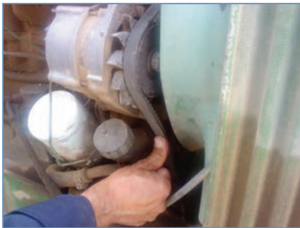
شکل ۲۸-۳ اندازه‌گیری کشش تسمه با فشار انگشت
