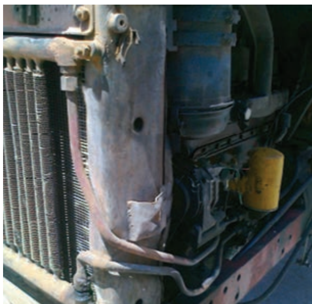
شکل ۱۲-۳- محل مهره‌های رادیاتور روغن
