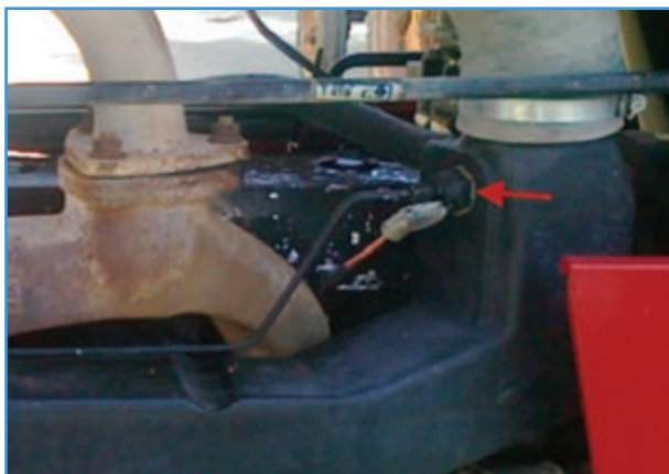
ب) شمع گرم کن تراکتور MF399
