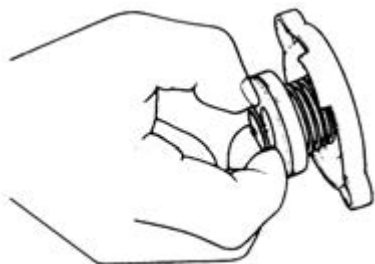
شکل ۱۷-۳- آزمون سوپاپ مکش در رادیاتور
