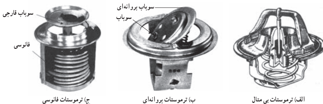
شکل ۱۹-۳ انواع ترموستات
