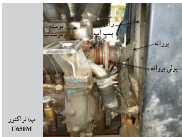
شکل ۳۵-۲ پمپ آب تراکتور
