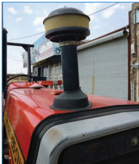
شکل ۲۵-۲. پیش صافی تراکتور MF285
