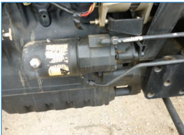
شکل ۲۳-۲. پمپ هیدرولیک فرمان و صافی تراکتور MF285
