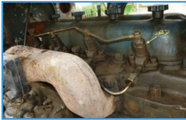
شکل ۳۲-۲ انژکتورهای تراکتور U650M
