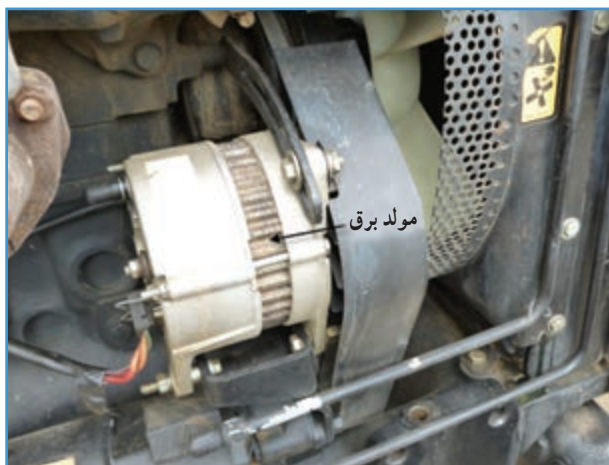
شکل ۴۷-۲ — مولد برق تراکتور MF285
