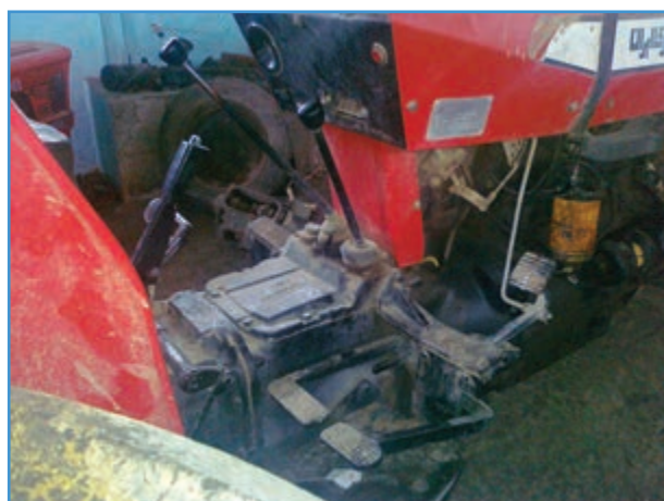
شکل ۲۱-۲ اهرم‌های تعویض دنده و دنده کمک
