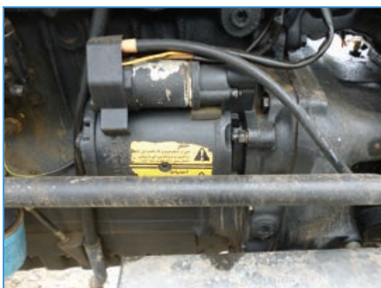
شکل ۴۵-۲- استارت تراکتور MF285
