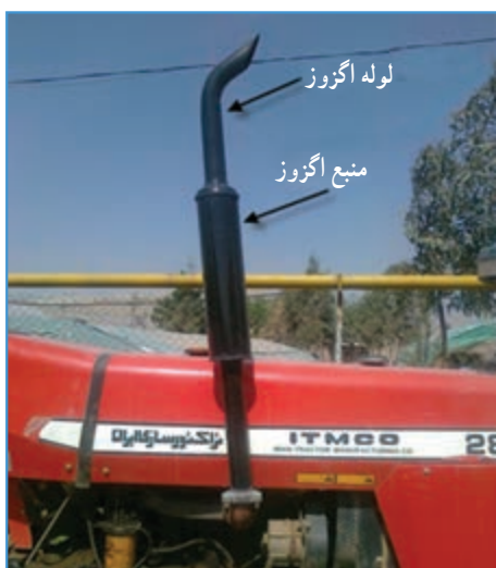
شکل ۲۷-۲. مانیفلد هوا و دود تراکتور MF399
