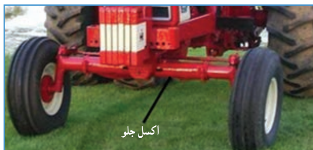
شکل ۲۲-۲ اکسل جلو تراکتور
