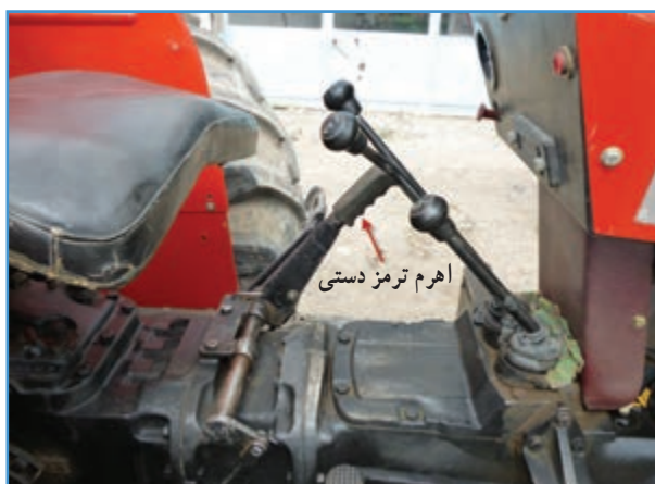
شکل ۱۹-۲ ترمز دستی تراکتور
