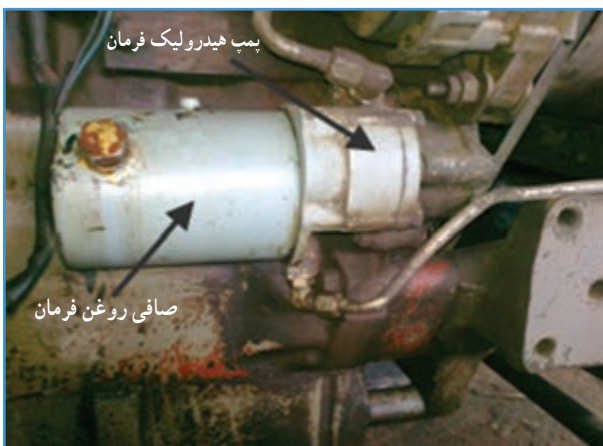
شکل ۲۳-۲. پمپ هیدرولیک فرمان و صافی تراکتور MF285
