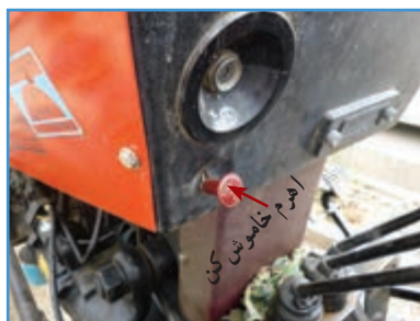
شکل ۱۳-۲ - اهرم خاموش کن تراکتور MF286
