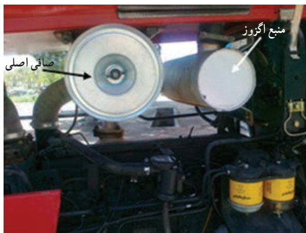
شکل ۲۶-۲. صافی اصلی تراکتور MF399
