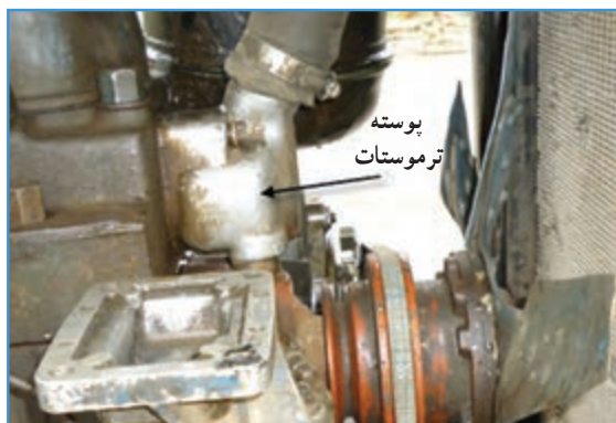
شکل ۳۷-۲ پوسته ترموستات تراکتور U650
