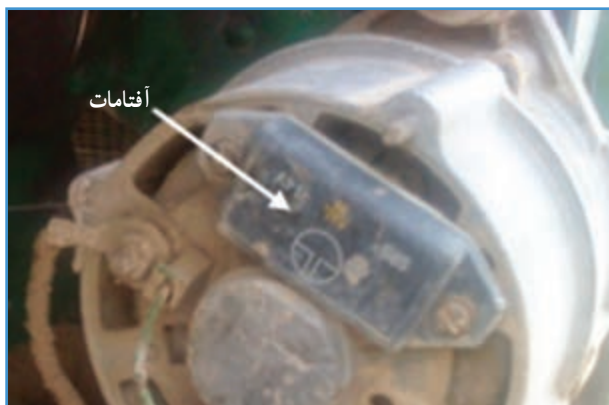
الف) آفتامات روی آلترناتور تراکتور JD3140
