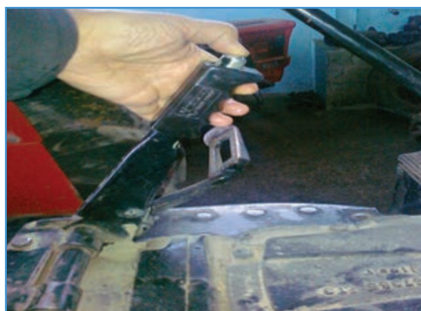
شکل ۱۹-۲ ترمز دستی تراکتور
