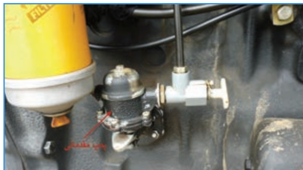
شکل ۲۹-۲- پمپ مقدماتی تراکتور MF285
