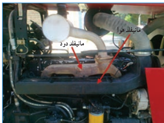
شکل ۲۷-۲. مانیفلد هوا و دود تراکتور MF399
