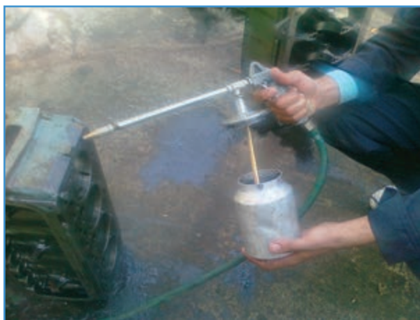
شکل ۱-۳- باز کردن مخزن پیستوله شستشو
