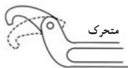
شکل ۵۹-۳ نحوه استفاده از آچار مهره‌ای گرد
