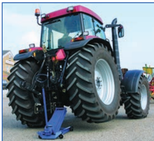
شکل ۱۳-۴ کاربرد جک سوسماری
