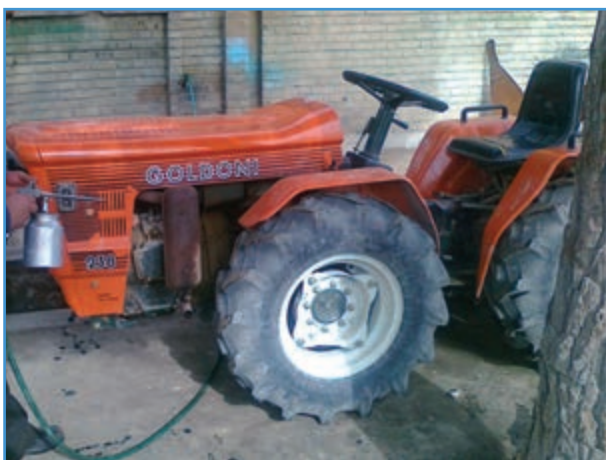
شکل ۱-۴- شستشوی موتور تراکتور با پیستوله شستشو
