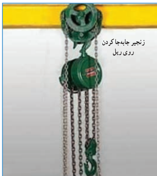
شکل ۲۰-۴ - اتصال جرثقیل سقفی به ریل
