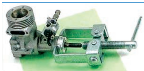
شکل ۷۷-۳- خارج کردن بلبرینگ با بلبرینگ کش
