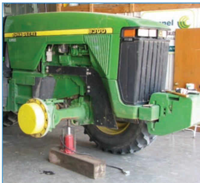
شکل ۱۱-۴- قرار دادن جک روغنی زیر جسم سنگین
