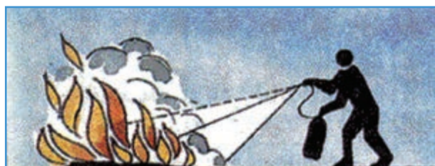
شکل ۱۳-۱- روش خاموش کردن آتش با پودر
