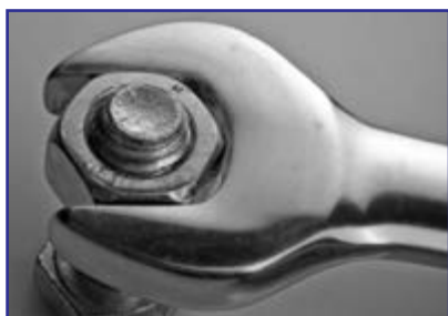
شکل ۲۸-۳ آچار تخت با سر زاویه دار (اینجی)
