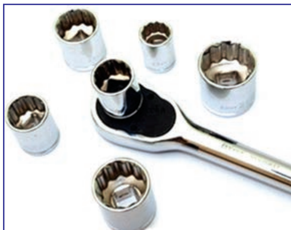
شکل ۴۸-۳ اتصال بکس به دسته بکس جفجغه ای
