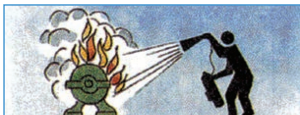
شکل ۱۴-۱- خاموش کردن آتش با دی اکسید کربن
