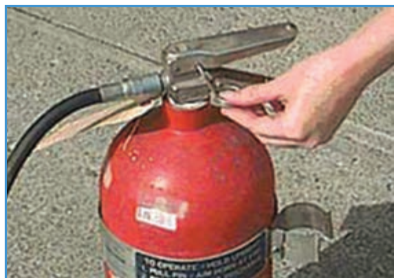
شکل ۱۱-۱- نحوه خارج کردن ضامن کپسول
