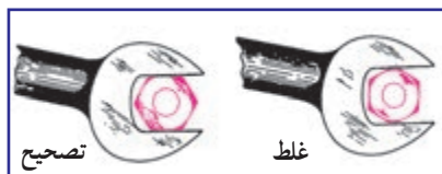
شکل ۲۹-۳ طرز درگیر کردن آچار تخت با مهره
