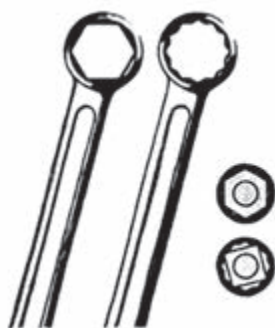
شکل ۳۰-۳- آچار رینگ با سر شش و دوازده گوش
