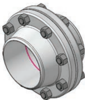
شکل ۳-۱- کاربرد پیچ و مهره برای اتصال
