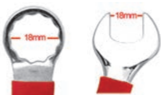
شکل ۳۲-۳- ابعاد آچار یک سر رینگ ۱۸ میلی متری
