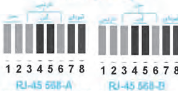
شکل (۳-۱۶) سرید پینهای RJ-45 براساس استاندارد 568A و 568B
