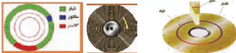
شکل ۳-۴ نمایش شیار، سکتور و کلاستر
