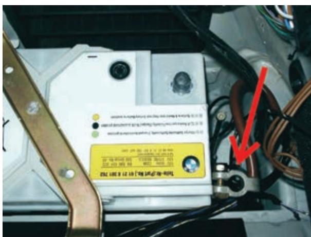
شکل ۹-۱۱- باز کردن کابل اتصال بدنه ی باتری
