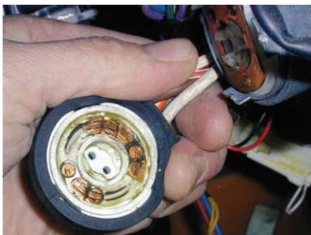
شکل ۱۱-۱۴- ترمینال داخل فیبری سوئیچ
