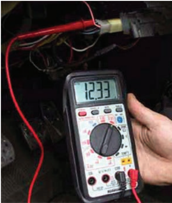
شکل ۲۸-۱۱- اندازه‌گیری ولتاژ در ترمینال ورودی سوئیچ
