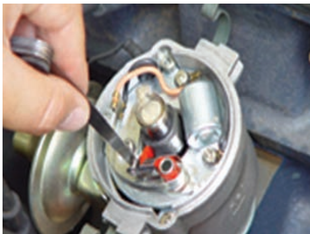
شکل ۴۸-۱۰- قرار دادن فیلر در دهانه‌ی پلاتین
