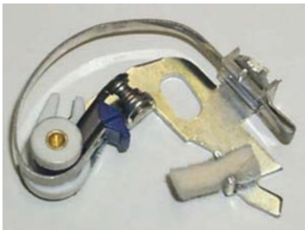
شکل ۲۲-۱۰- نمد روغن کاری بادامک
