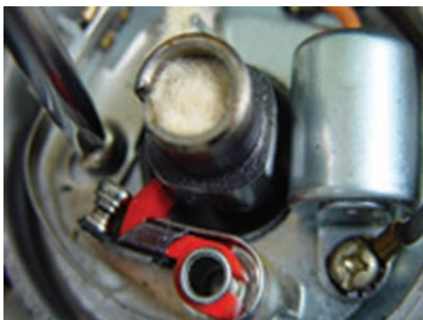
شکل ۵۰-۱۰- محکم کردن پیچ پلاتین پس از تنظیم دهانه
