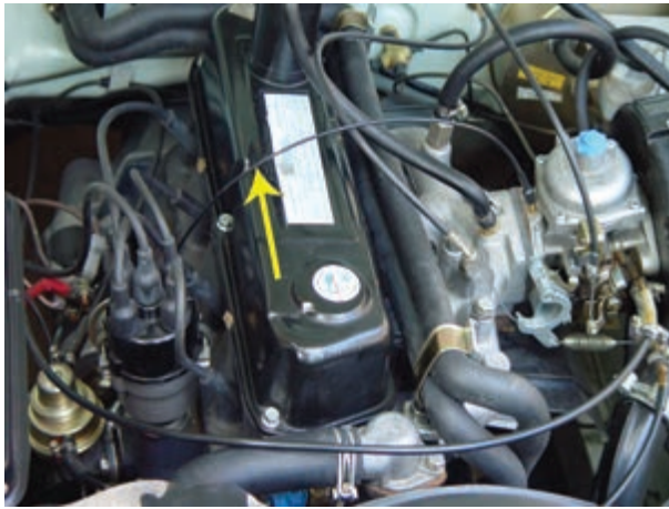
شکل ۲۸- ۱۰- لوله‌ی رابط آوانس خلی به کاربراتور
