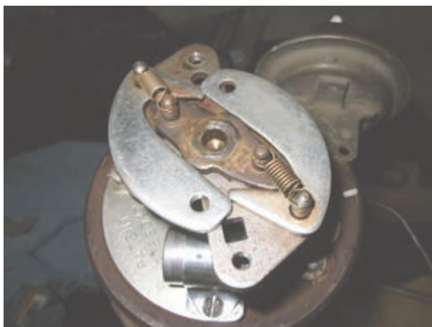
شکل ۲۴-۱۰- دستگاه آوانس وزنه‌ای دلکو
