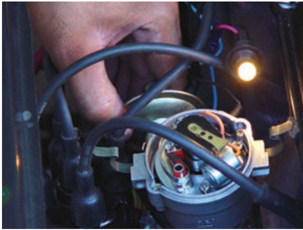
شکل ۶۰-۱۰- لحظه‌ی باز شدن دهانه پلاتین و روشن شدن لامپ
