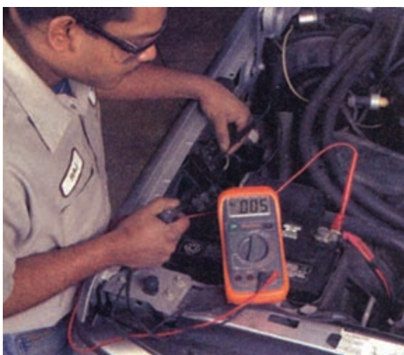
شکل ۸-۴۱- اندازه‌گیری افت ولتاژ کابل متصل به رله
