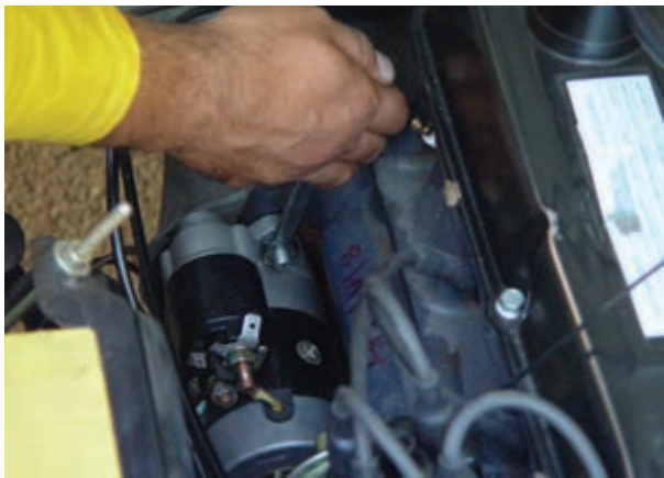
الف- باز کردن پیچ‌های استارتر
