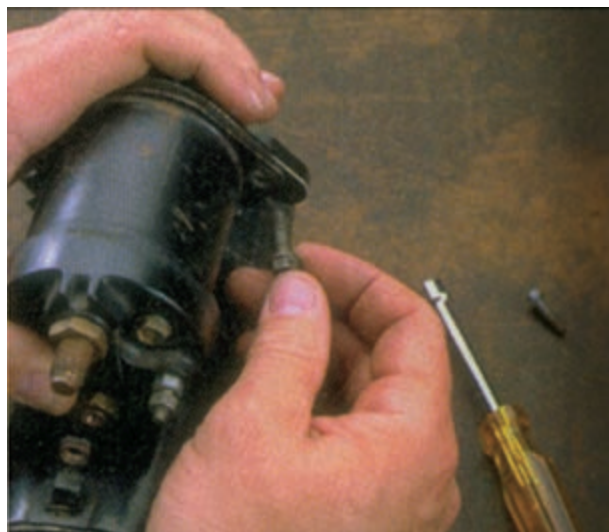
شکل ۸-۵۳ - بیرون آوردن پیچ‌های اتومات
