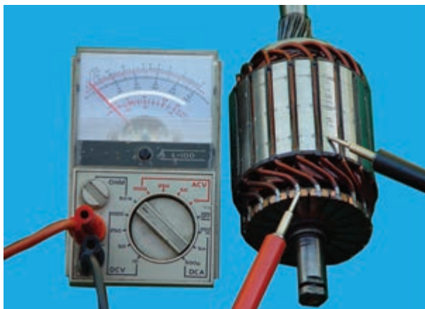
شکل ۸-۶۷- آزمایش اتصال کوتاه شدن آرمیچر
