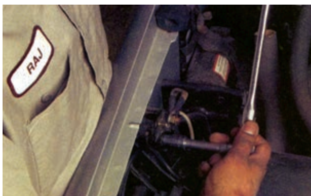
شکل ۸-۴۵ - اندازه‌گیری افت ولتاژ رله‌ی استارتر
