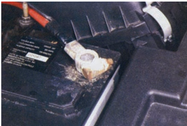
شکل ۳۱-۸ سولفات‌شدن اتصال قطب باتری
