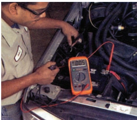
شکل ۸-۴۰- اتصال سیم منفی ولت‌متر به ورودی رله
