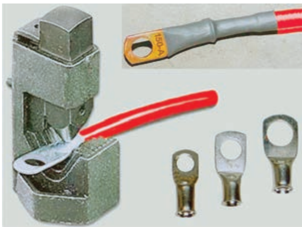
شکل ۸۰-۸- اتصال بست به کابل باتری
