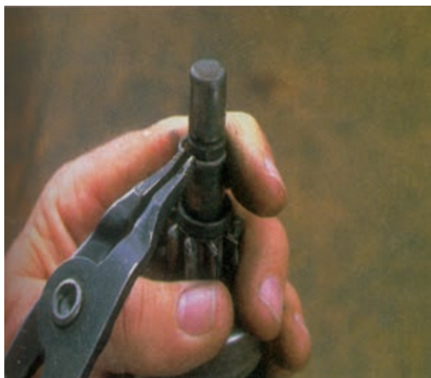
شکل ۸-۶۱ – درآوردن خار رینگی
