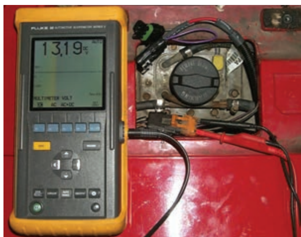
شکل ۸-۴۶- اندازه‌گیری ولتاژ مدار
