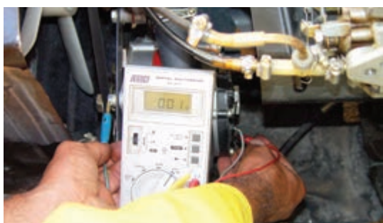
شکل ۷-۷۲ - اتصال ولت‌متر بین ترمینال B و بدنه
