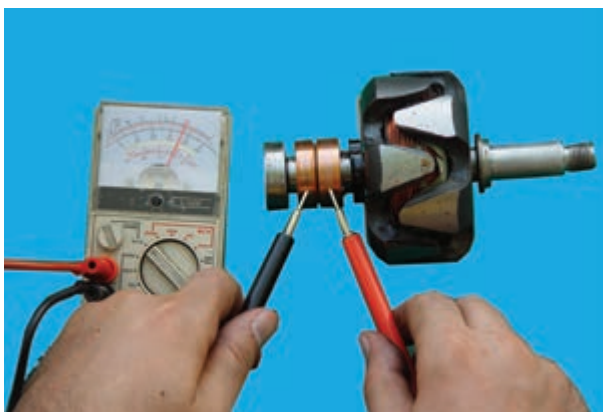
شکل ۷۵-۷- آزمایش سالم بودن سیم پیچ روتور
