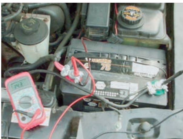
شکل ۷-۱۰۲- اندازه‌گیری ولتاژ شارژ
