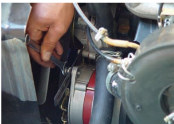
شکل ۴۹-۷ باز کردن پیچ کشش تسمه پروانه
