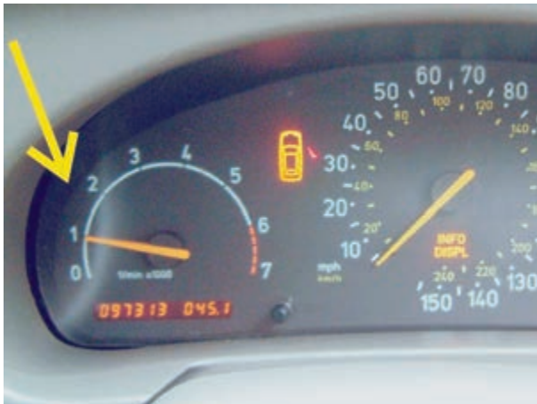
شکل ۷-۱۰۰- حالت دور آرام موتور
