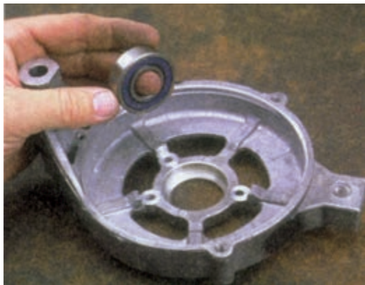
شکل ۷۰-۷ - خارج کردن بلبرینگ و آزمایش آن
