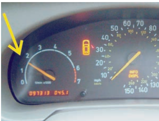
شکل ۷-۱۰۱- افزایش دور موتور برای آزمایش
