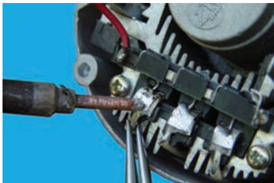
شکل ۷-۵۶- جدا کردن سیم‌های استاتور از یک‌سوکننده
