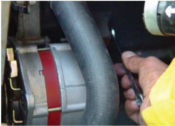
الف - بازکردن پیچ‌های پایه‌ی آلترناتور
