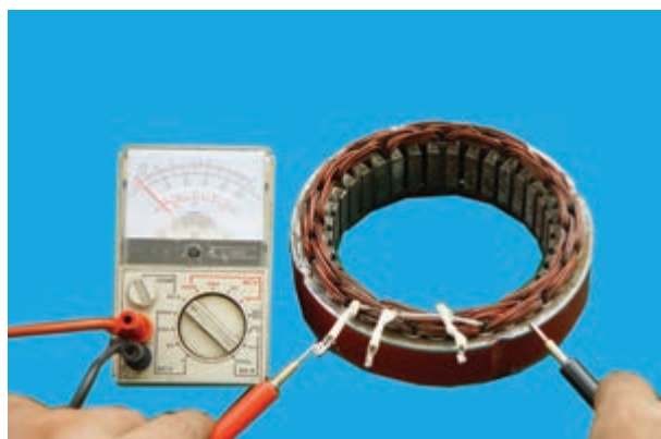
شکل ۷-۷۸ - آزمایش اتصال بدنه نبودن سیم پیچ استاتور
