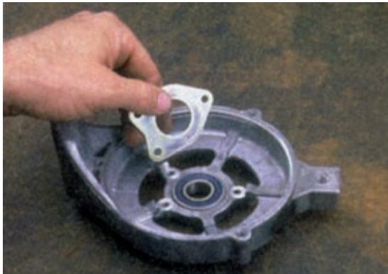
شکل ۶۸-۷ - در آوردن نگه‌دارنده‌ی بلبرینگ
