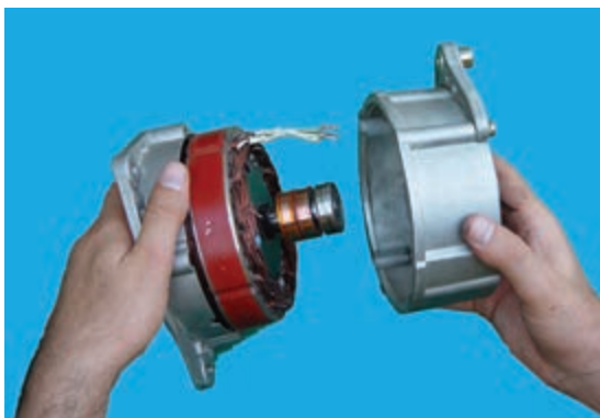
شکل ۶۱-۷ - جدا کردن درپوش‌های آلترناتور
