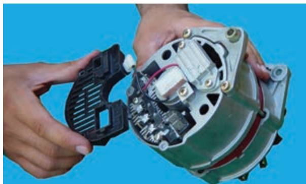
شکل ۷-۵۲- بازکردن درپوش دیودها
