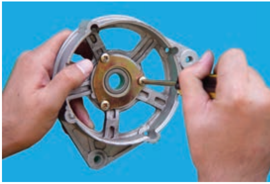
شکل ۶۷-۷ - باز کردن پیچ‌های نگه‌دارنده‌ی بلبرینگ
