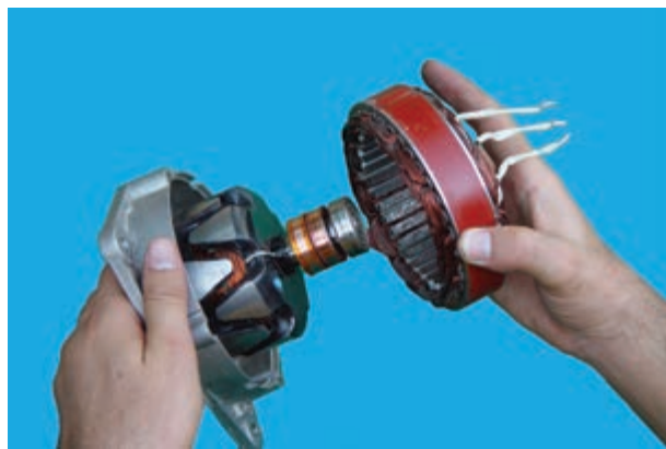
شکل ۶۲-۷ - جدا کردن استاتور
