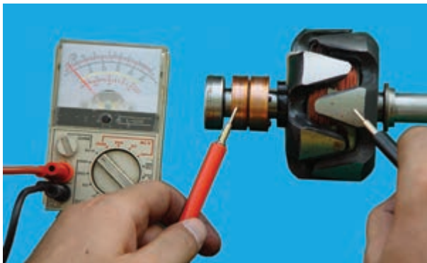
شکل ۷۴-۷- آزمایش اتصال بدنه نبودن سیم پیچ روتور
