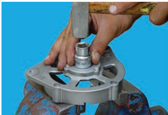
شکل ۶۹-۷ - بیرون آوردن بلبرینگ
