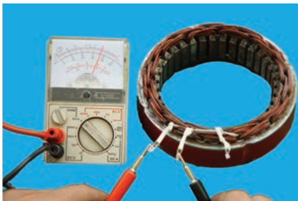
شکل ۷۹-۷- آزمایش سالم بودن سیم پیچ استاتور
