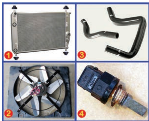
شکل ۲-۶- اجزای مدار خنک کاری
