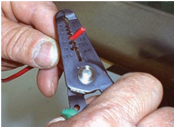
شکل ۶-۳۰ جدا کردن عایق سیم
