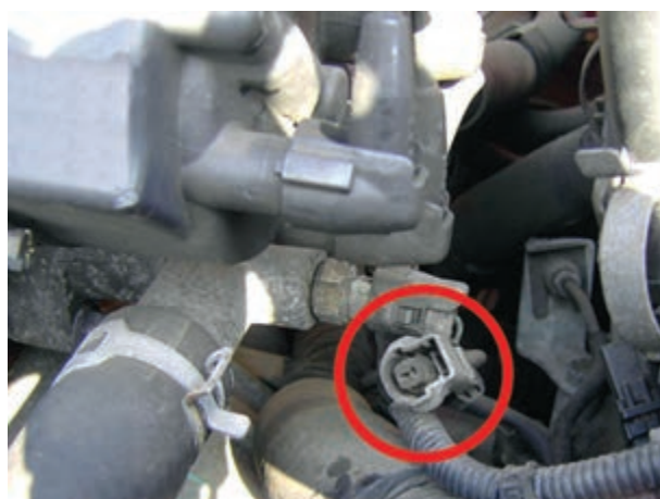
شکل ۱۶-۶ جدا کردن سوکت اتصال
