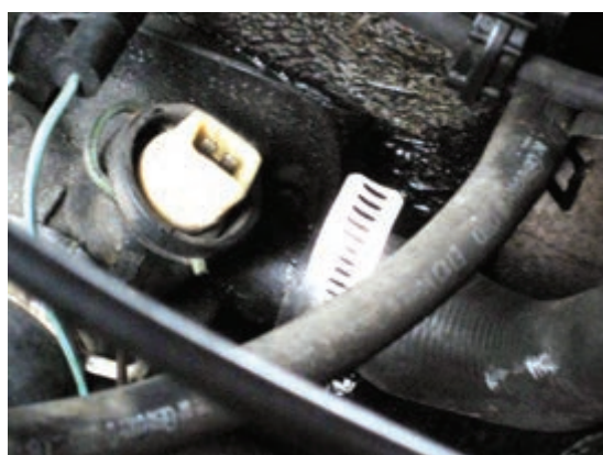
شکل ۲۵-۶ ترمینال‌های سنسور حرارتی مدار خنک‌کاری
