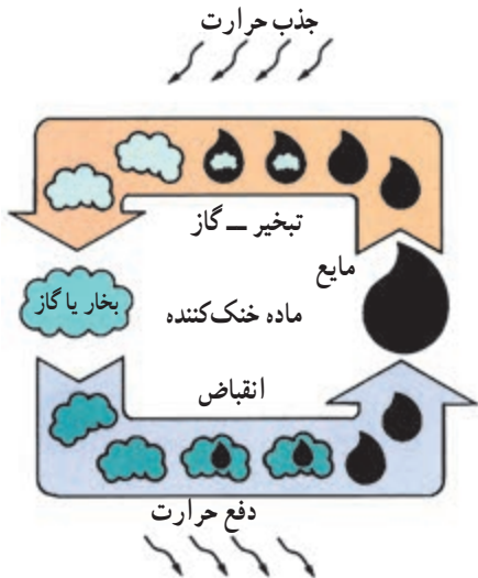
شکل ۵-۳- مراحل تغییر ماده خنک‌کننده
