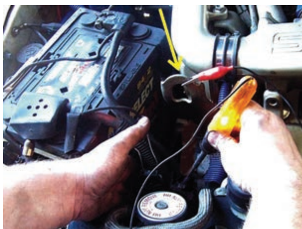
شکل ۴۳-۵- نحوه ی آزمایش سالم بودن سیم کشی
