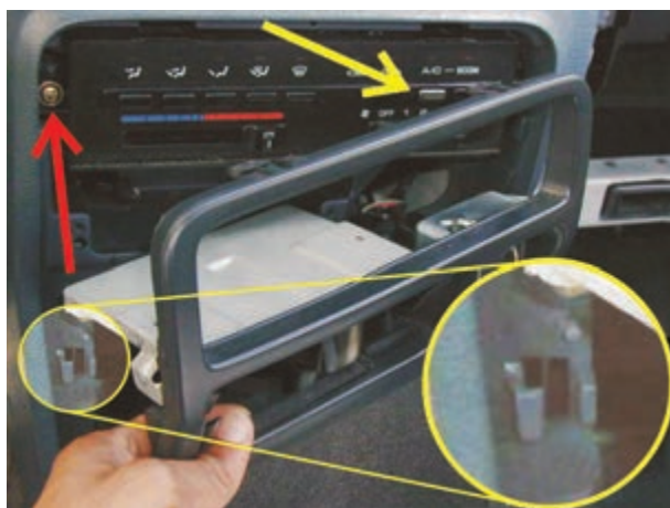
شکل ۳۸-۵- باز کردن قاب سوئیچ‌ها
