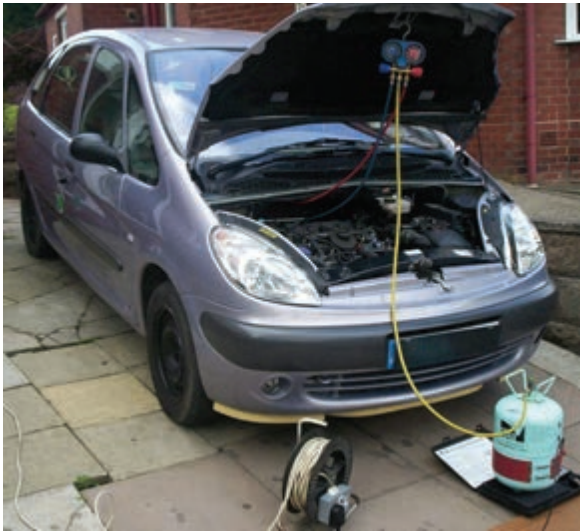
شکل ۳۵-۵ شارژ گاز کولر
