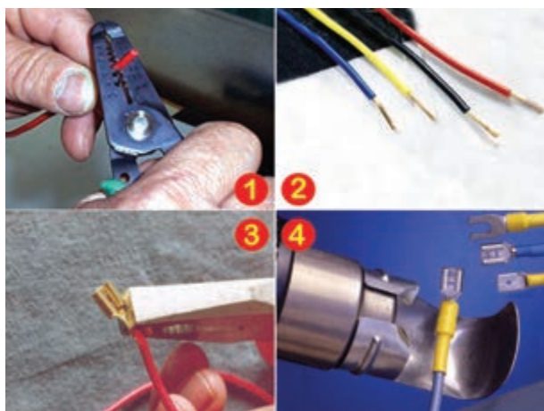
شکل ۴۷-۵- آماده کردن سیم‌ها برای سیم‌کشی
