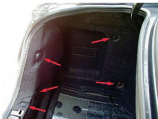
شکل ۲۰-۵- خارهای پلاستیکی کاور صندوق عقب
