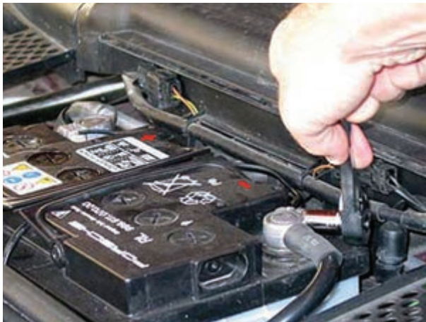
شکل ۱۸-۵- باز کردن کابل اتصال بدنه‌ی باتری
