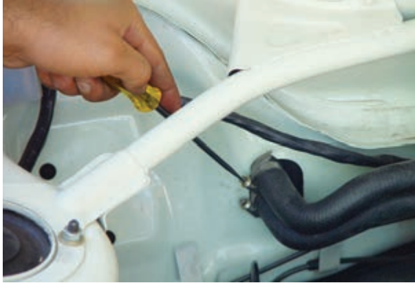
شکل ۴-۳۱- باز کردن لوله های آب رادیاتور بخاری
