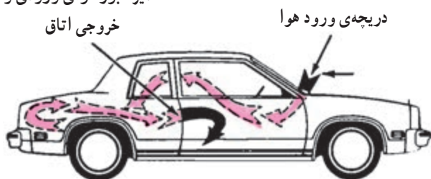
شکل ۴-۱۱- مسیر عبور جریان هوای گرم در خودرو
