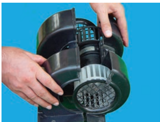
شکل ۴-۴۰- جدا کردن محفظه‌ی نگهدارنده‌ی موتور
