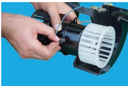
شکل ۴-۴۱- جدا کردن سیم از زغال‌ها
