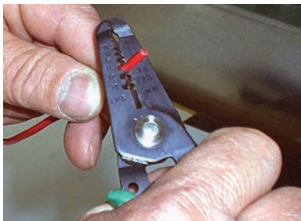
شکل ۴-۶۴- جدا کردن عایق سیم‌ها
