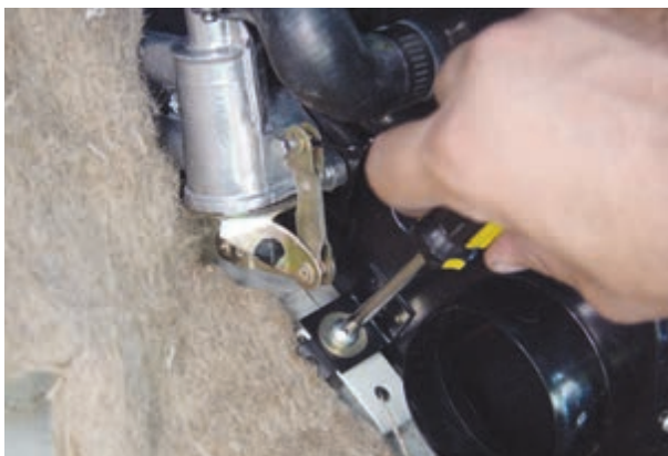
شکل ۴-۳۳- پیچ های پایه ی بخاری
