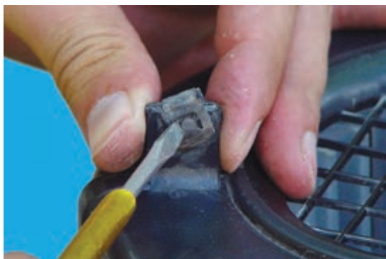
شکل ۴-۳۸- باز کردن ضامن خار
