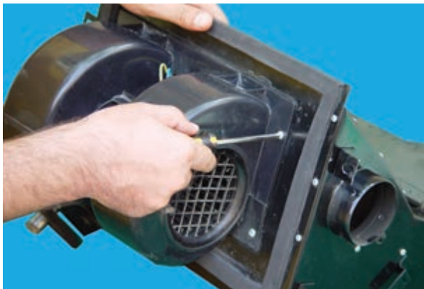
شکل ۴-۳۶- باز کردن پیچ‌های محافظه‌ی موتور
