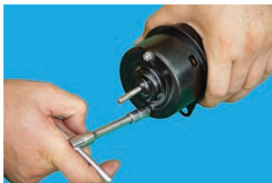
شکل ۴-۴۴- باز کردن پیچ‌های پوسته‌ی موتور
