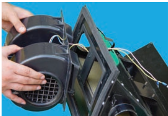
شکل ۴-۳۷- جدا کردن محفظه‌ی موتور از بخاری
