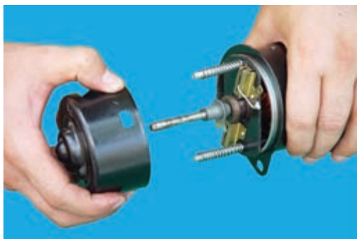
شکل ۴۵-۴ جدا کردن پوسته‌ی موتور
