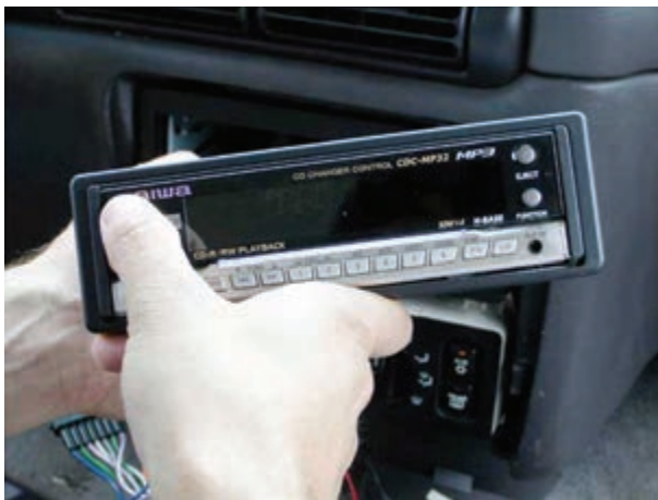
شکل ۴-۲۸- خارج نمودن رادیوپخش از داخل قاب کشویی
