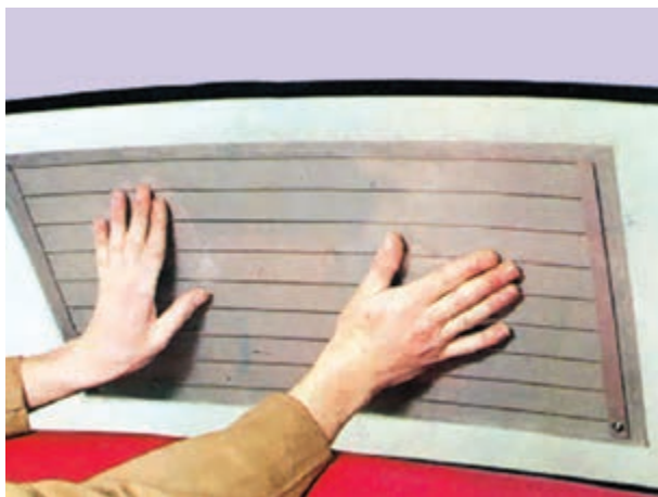
شکل ۹-۳- نحوه چسباندن المنت حرارتی
