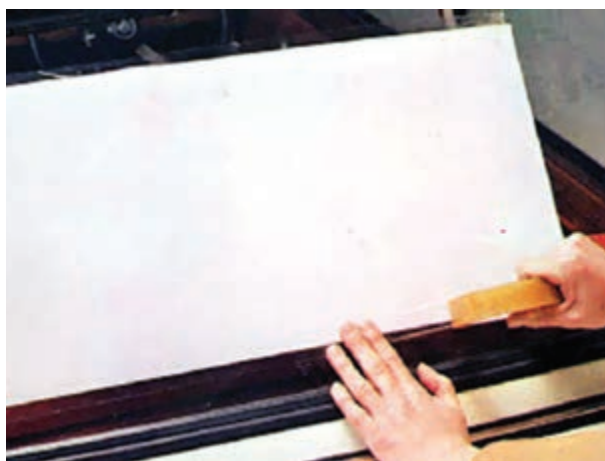
شکل ۳-۷ - صفحه‌ی راهنمای نصب المنت حرارتی
