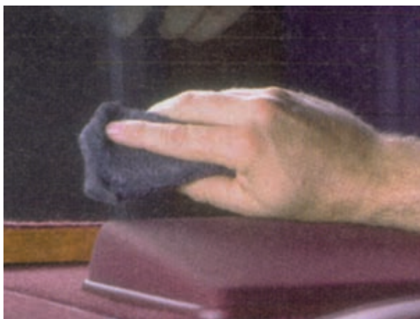
شکل ۳-۲۲- تمیز کردن محل قطع شده‌ی المنت حرارتی
