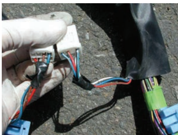
شکل ۳-۲۳- مقایسه و تطبیق سوکت‌های کلاف سیم کشی
