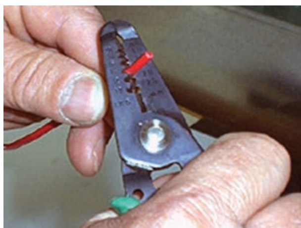
شکل ۳-۳۸- جدا کردن عایق سر سیم‌ها
