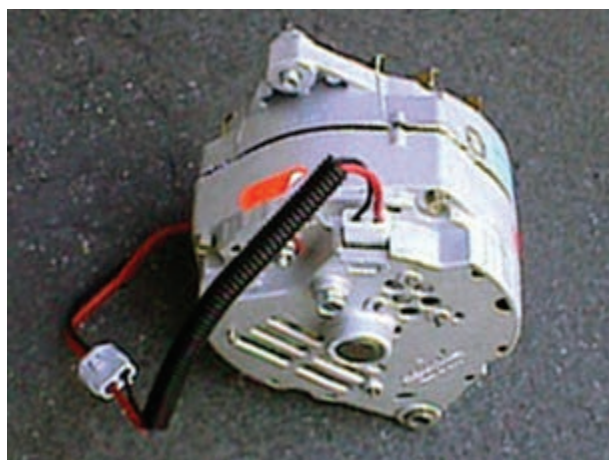
شکل ۳-۱۶- آلترناتور مجهز به آفتامات الکترونیکی
