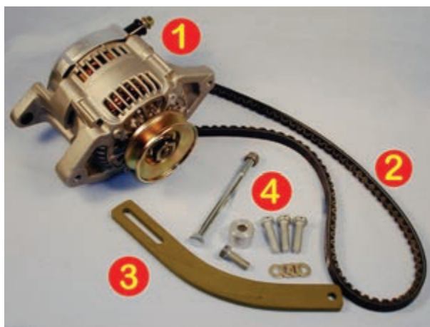
شکل ۳-۵- آلترناتور و متعلقات آن
