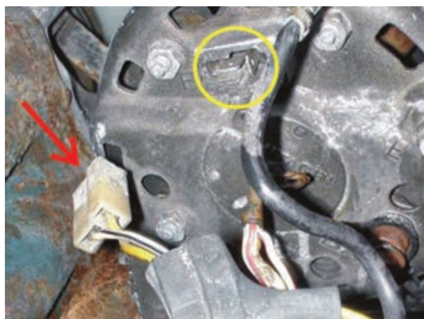
شکل ۳-۳۵ جدا کردن کاتوچویی سیم کشی لامپ شارژ
