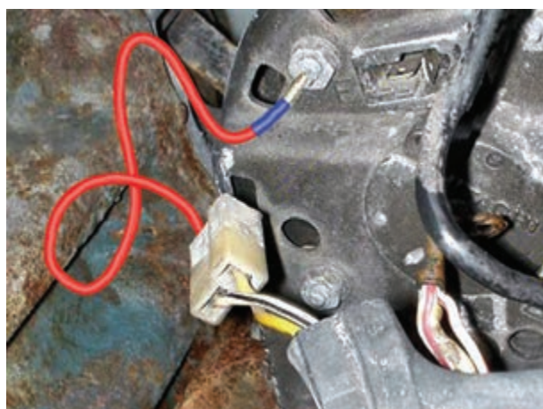
شکل ۳-۳۶ آزمایش مدار لامپ شارژ
