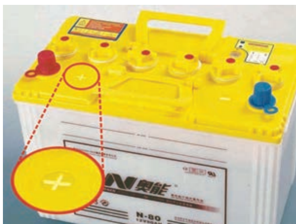
شکل ۲-۹- کاربرد علائم برای تشخیص قطب‌های باتری
