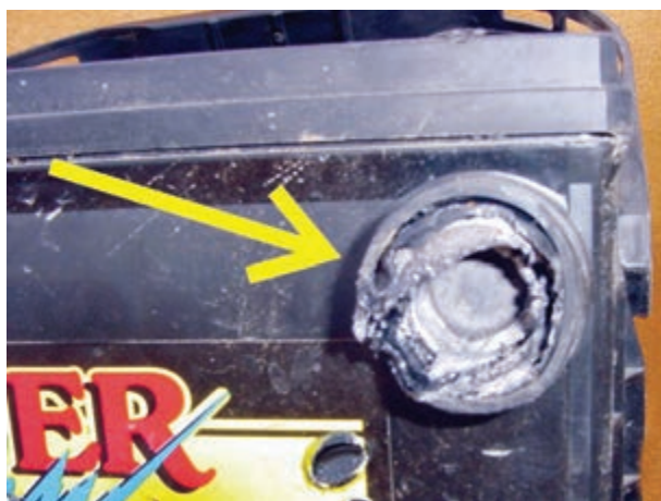
شکل ۳۶-۲- معیوب بودن ترمینال باتری
