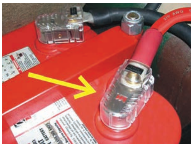
شکل ۱۹-۲- مورد استفاده تلق محافظ قطب‌های باتری
