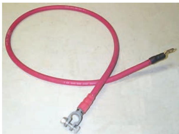
شکل ۳۲-۲- کابل اتصال مثبت باتری
