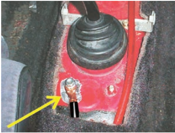
شکل ۲-۲۵- اتصال بدنه‌ی باتری در داخل اتاق خودرو
