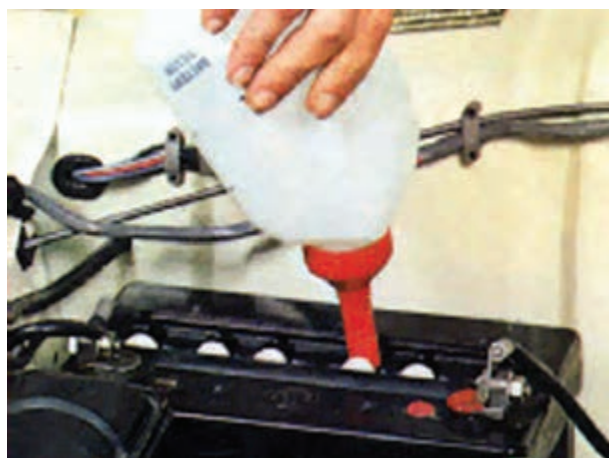
شکل ۱-۷۴- کنترل سطح الکترولیت
