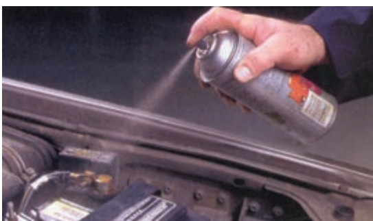
شکل ۱-۹۶- پاشیدن محلول ضد خوردگی روی بست
