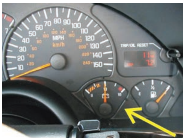
شکل ۱-۷۸ – نشان دهنده‌ی وضعیت شارژ باتری
