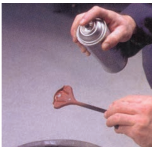
شکل ۹۳-۱- اسپری ضدخوردگی روی بست نگه‌دارنده‌ی باتری
