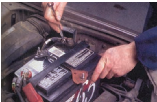
شکل ۱-۹۵- اتصال کابل‌های مثبت و منفی باتری
