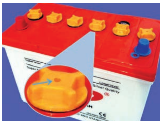
شکل ۱-۷۵- سوراخ روی درپوش خانه باتری
