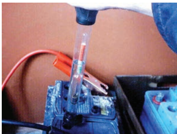
شکل ۱-۵۳- کنترل غلظت الکترولیت
