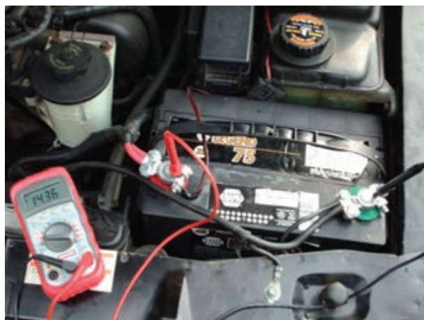
شکل ۱-۶۶ — اندازه گیری ولتاژ باتری
