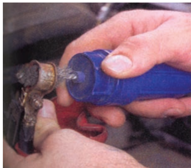
شکل ۹۱-۱ - پاک کردن بست‌های باتری با برس سیمی
