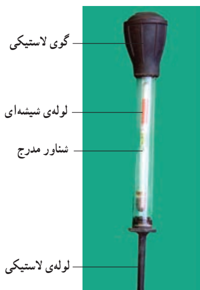
شکل ۱-۱۴- دو نوع هیدرومتر یا چگالی سنج
