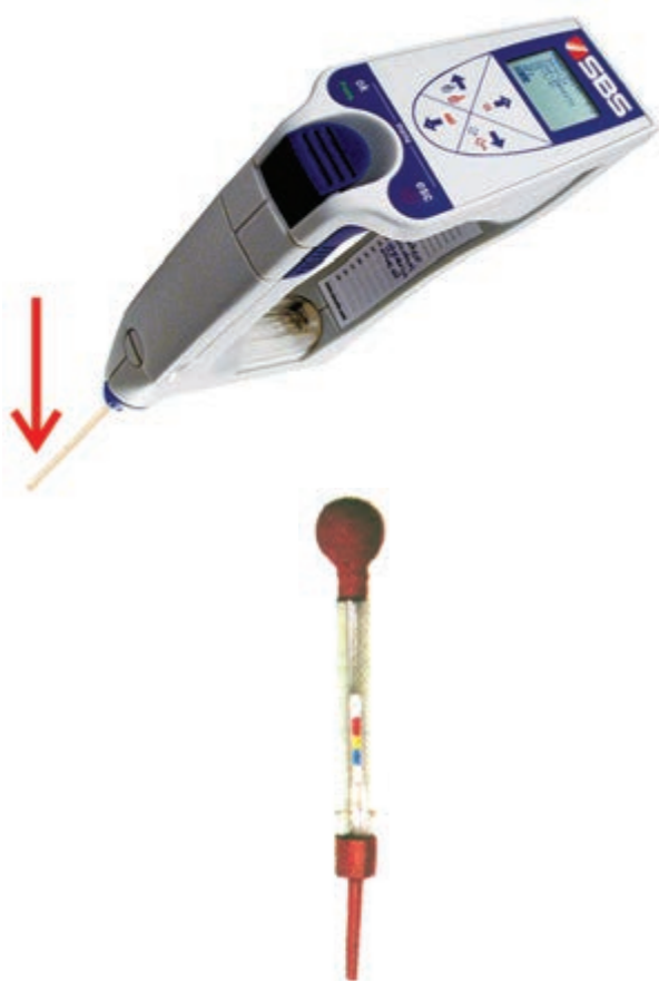
شکل ۱-۲۳ - هیدرومتر (اسیدسنج)
