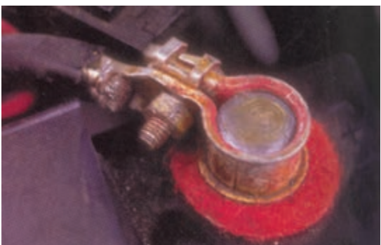
شکل ۱-۹۷- گریس زدن بست قطب‌ها
