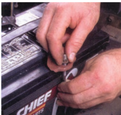
شکل ۹۴-۱- بستن باتری روی خودرو
