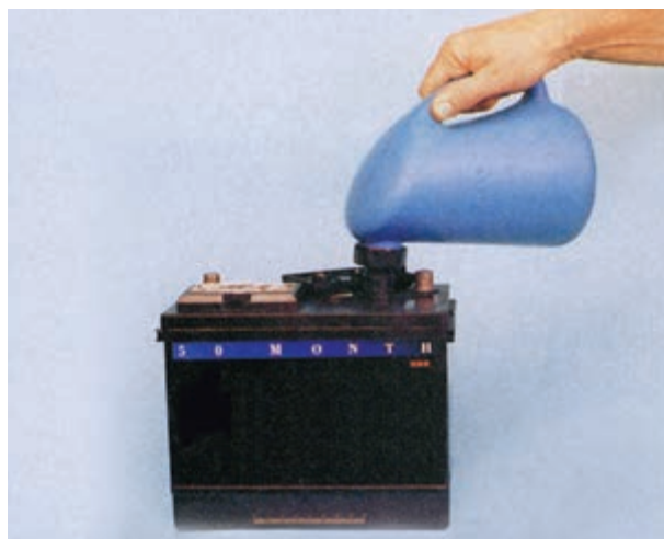
شکل ۲۷-۱- پر کردن خانه‌های باتری نو با الکترولیت
