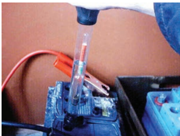
شکل ۱-۶۲- کنترل غلظت الکترولیت
