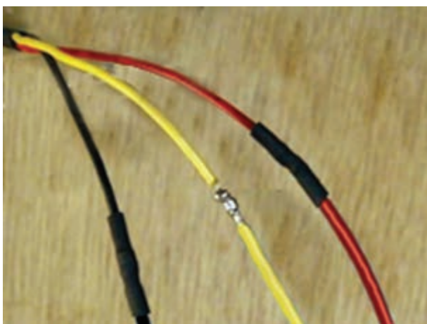
شکل ۱-۷۴- رفع عیب سیم کشی مدار الکتریکی
