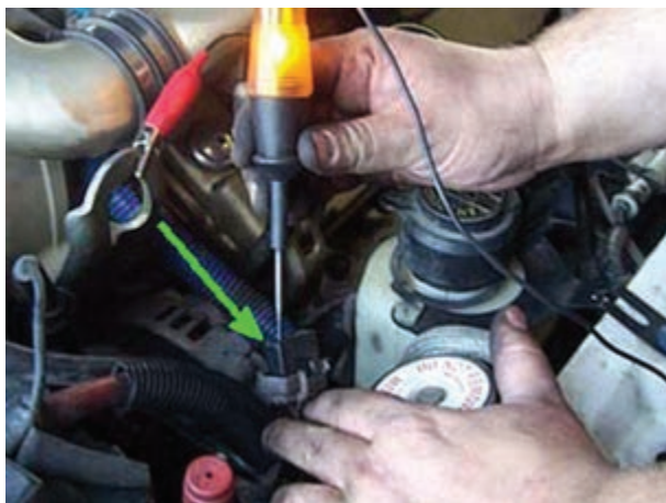
شکل ۱-۷۳- آزمایش سیم کشی مدار
