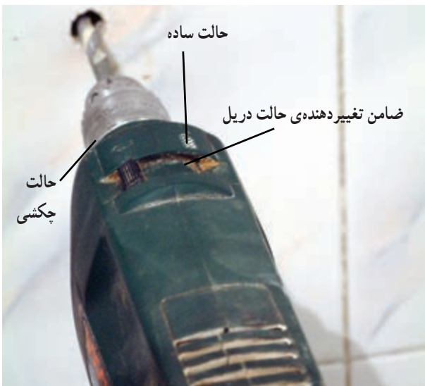
شکل ۲۱۲-۳ سوراخ کردن محل علامت‌گذاری شده
