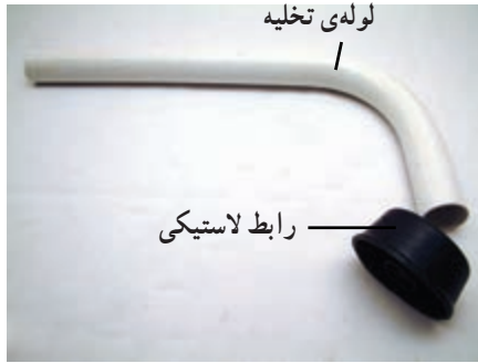
شکل ۲۳۱-۳- الف - لوله تخلیه و رابط لاستیکی
