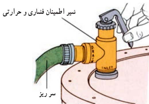
شکل ۲-۱۰۹- شیر اطمینان فشاری - حرارتی
