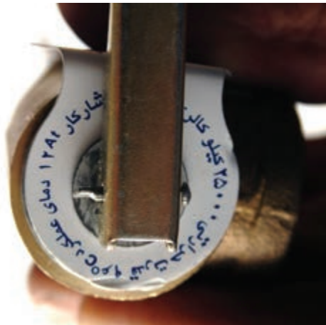
شکل ۲-۱۰۸- شیر اطمینان فشاری و حرارتی
