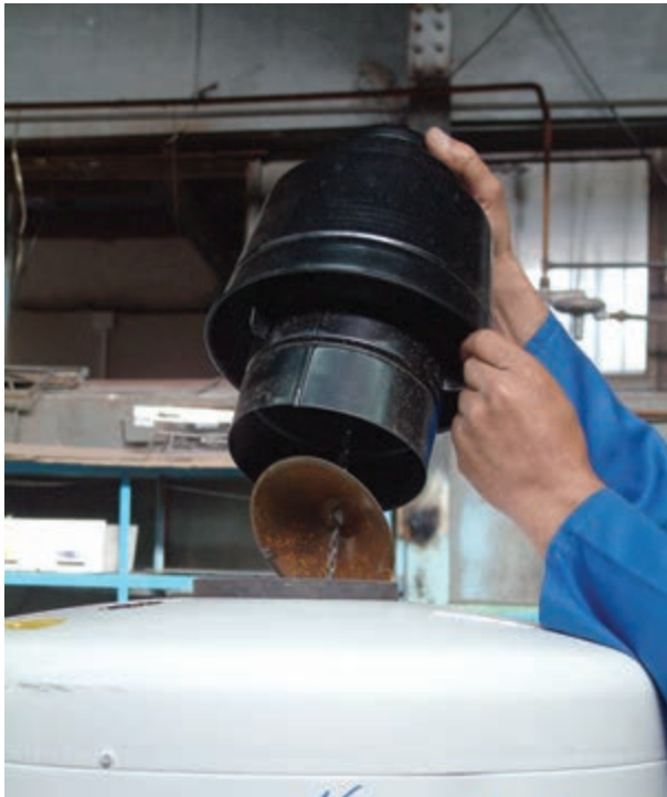
شکل ۱-۱۱۵- برداشتن کلاهک تعدیل از روی دودکش
