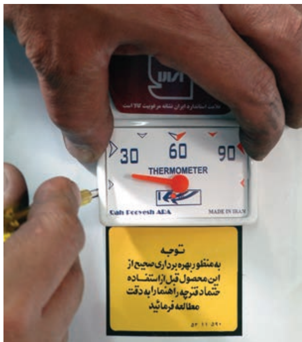
شکل ۱-۱۱۷ جدا کردن ترمومتر از روپوش
