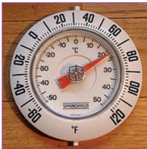
شکل ۳-۵ - دماسنج با دو مقیاس
