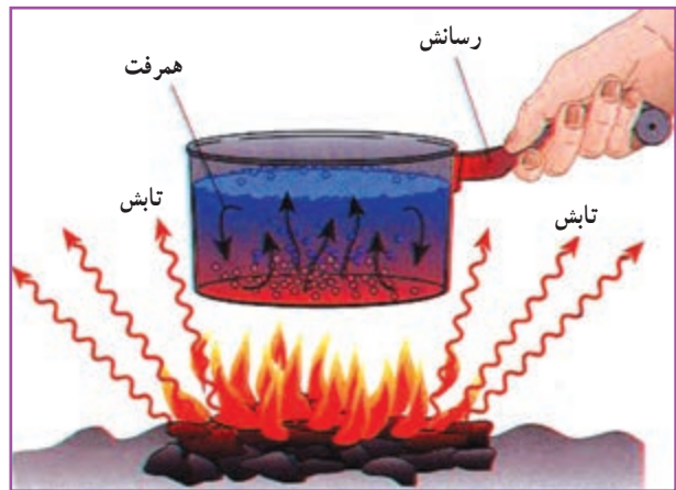
شکل ۳-۱۱- انتقال گرما به هر سه روش
