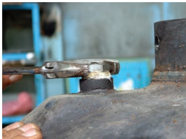
شکل ۱-۲۴- نحوه‌ی بازکردن میله‌ی منیزیم از محل خود
