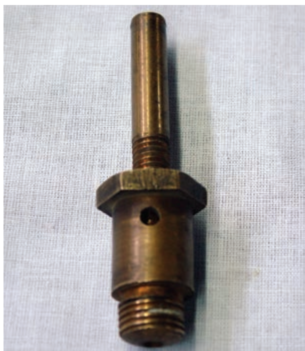
شکل ۱-۳۲- شیر قطع و وصل مخزن سوخت
