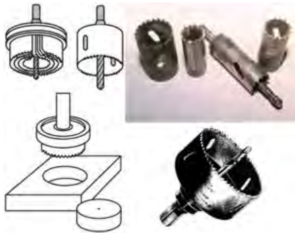
شکل ۱۲-۲۸. سر مته‌ی گردبر و کاربرد آن.
