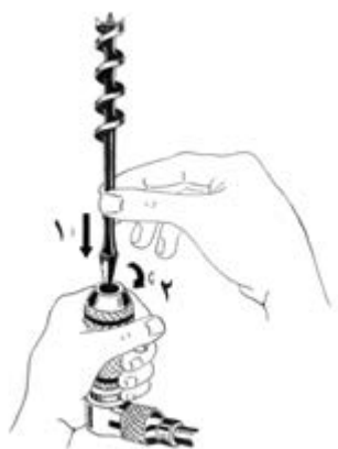
شکل ۱۲-۳۵- بستن سر مته به دریل.
