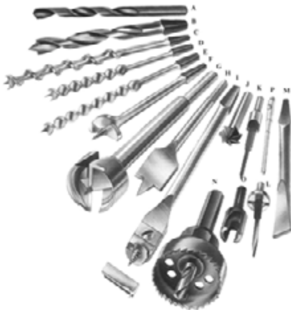
شکل ۱۲-۱۱- انواعی از سر مته‌های مخصوص چوب.
