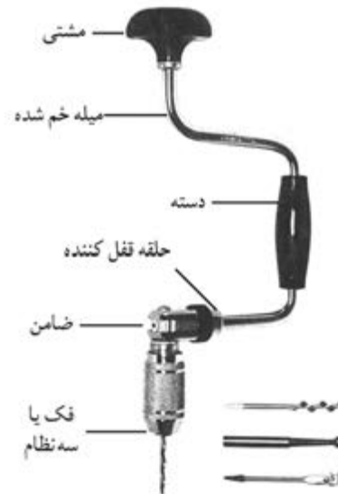
شکل ۱۲-۱. قسمت‌های مختلف دریل شتر گلو، همراه با چند سر مته با دنباله‌های مختلف.
