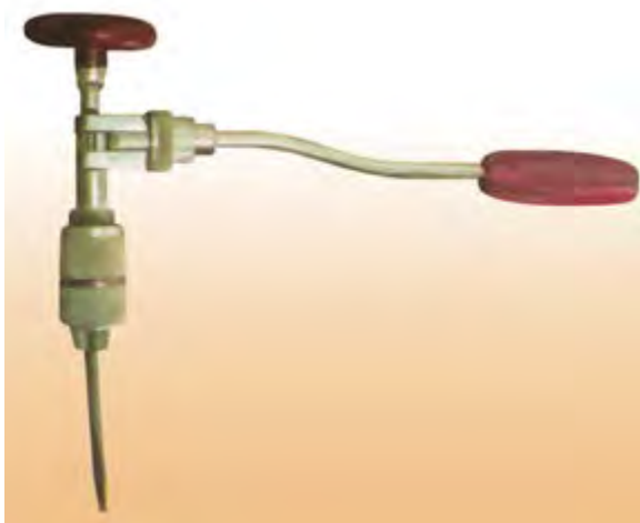
شکل ۱۲-۲. دریل شتر گلو، مخصوص گوشه کار.
