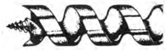
شکل ۱۲-۲۱. سر مته‌ی مدل دو گلاس.
