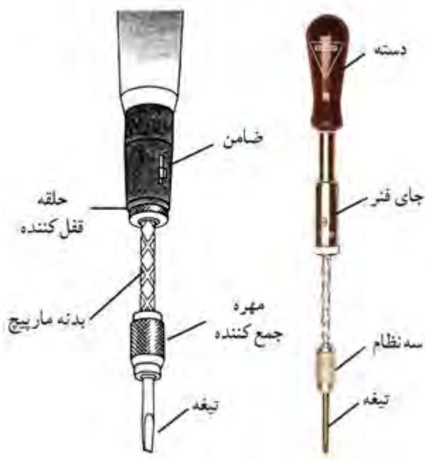
شکل ۱۲-۷. قسمت‌های مختلف یک دریل فشاری.
