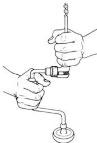
شکل ۱۲-۴۱. بستن و محکم کردن سر مته در داخل دریل.
