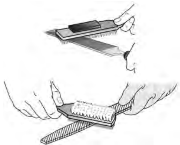
شکل ۱۱-۲۹- تمیز کردن سوهان با برس.
