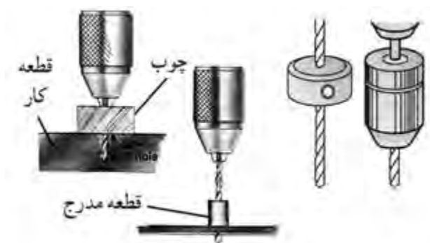
شکل ۱۲-۳۹. چند نوع عمق‌سنج دریل.
