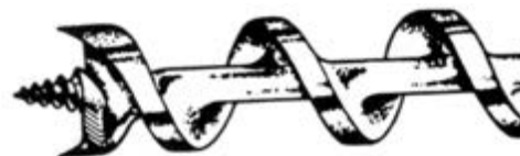
شکل ۱۲-۲۳- سر مته‌ی مدل ابروین.
