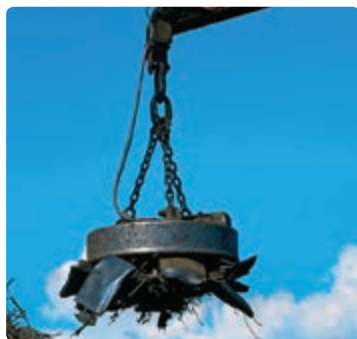
شکل ۴-۲۰ سیملوله با هسته آهنی
