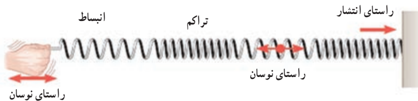
شکل ۱۰-۴- انتشار موج طولی در فنر
