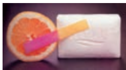
شکل ۵ نوار کاغذی سیر شده با متیل سرخ. این شناساگر در محیط های اسیدی به رنگ سرخ و در محلول های بازی به رنگ زرد درمی آید.
