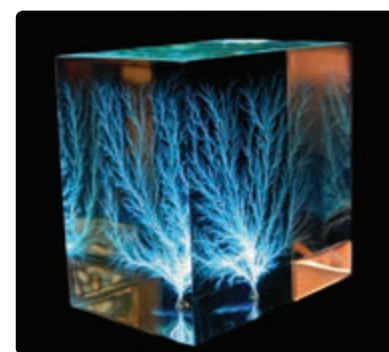
شکل ۲-۳۰ فروریزش الکتریکی باعث تشکیل مسیرهای رسانایی سرخس‌شکلی در دی‌الکتریک شده‌اند.
