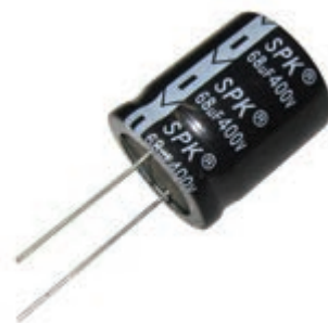
شکل ۲-۳۱ تصویری از یک خازن که روی آن ظرفیت و اختلاف پتانسیل قابل تحمل بیشینه نوشته شده است.
