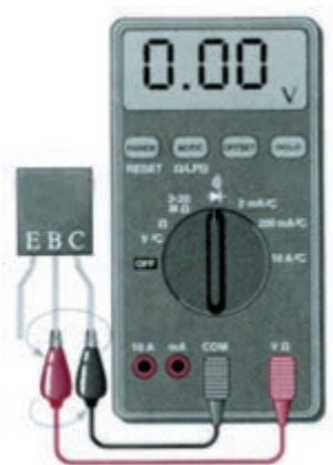
شکل ۵۰-۱۲ ترانزیستور معیوب (اتصال کوتاه)
