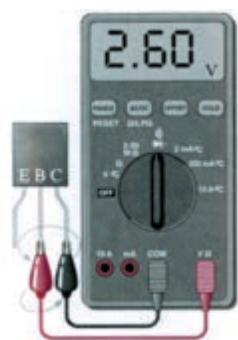
شکل ۴۹-۱۲ ترانزیستور معیوب (قطع)
