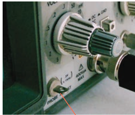
خروجی موج مربعی با فرکانس 1 KHz و 0.5 ولت
