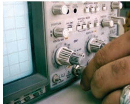
شکل ۶-۶ نحوه‌ی اتصال BNC به اسیلوسکوپ
