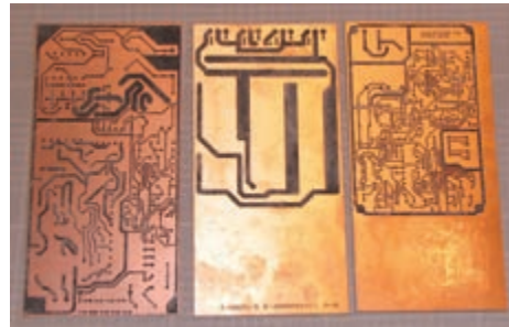
شکل ۷-۶ انتقال مدار چاپی روی فیبر
