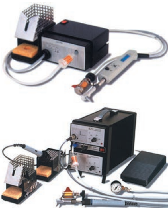
شکل ۴۸-۳ نحوه‌ی قرارگیری قلع کش حرارتی
