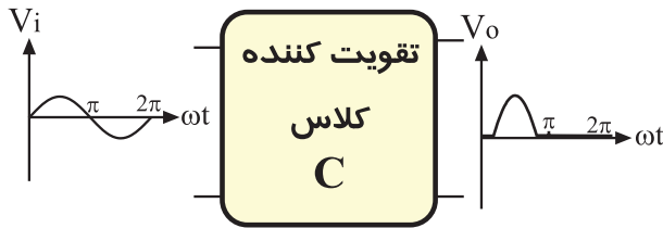
شکل ۳-۶ تقویت کننده کلاس C
