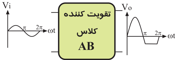
شکل ۳-۵ تقویت کننده کلاس AB
