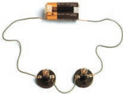
شکل ۲-۲۹ مدار واقعی دو لامپ به صورت سری
