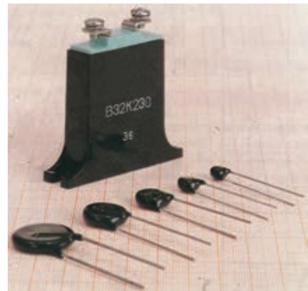
شکل ۱۴-۲ شکل ظاهری واریستور و نماد آن
