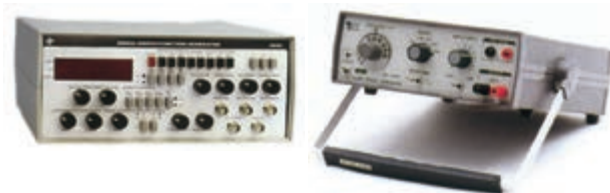
الف - سیگنال ژنراتور ب - فانکشن ژنراتور
