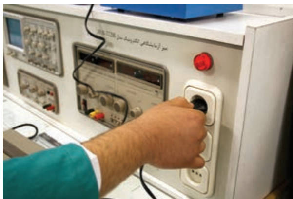
شکل ۱-۳۸ اتصال صحیح دو شاخه
