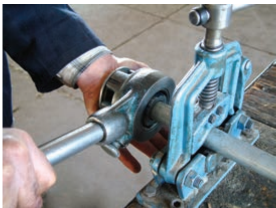
شکل ۵-۱۵۱- حدیده کردن لوله‌ها
