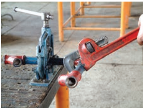
شکل ۱۴۰-۵- بستن ضلع دوم مدار مثلث شکل
