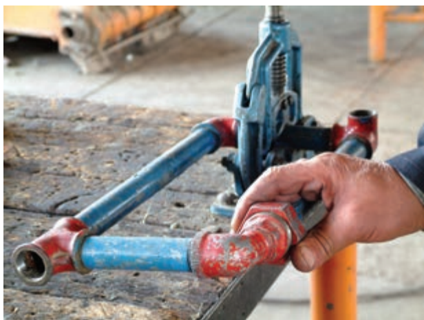
شکل ۱۶۰-۵- بستن مهره ماسوره به وسیله‌ی دست
