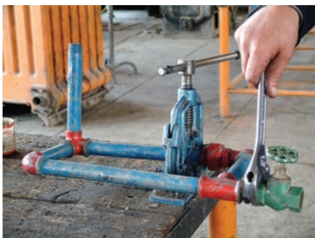
شکل ۱۶۳-۵- بستن شیر فلکه به سهراهی ۹۰ درجه و تکمیل نمودن مدار
