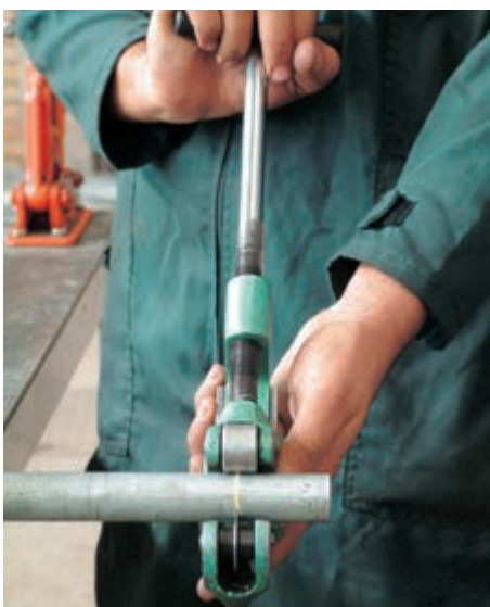
شکل ۱۳۵-۵- بریدن لوله‌های مورد نیاز
