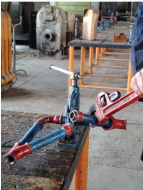
شکل ۱۴۱-۵- بستن یکی از قطعات به سهراهی
