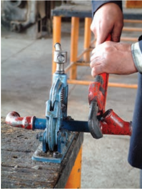
شکل ۱۳۹-۵- بستن فیتینگ‌ها به لوله‌های حدیده شده
