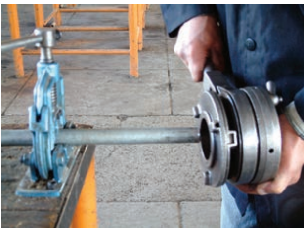
شکل ۱۳۶-۵- حدیده کردن لوله‌ها
