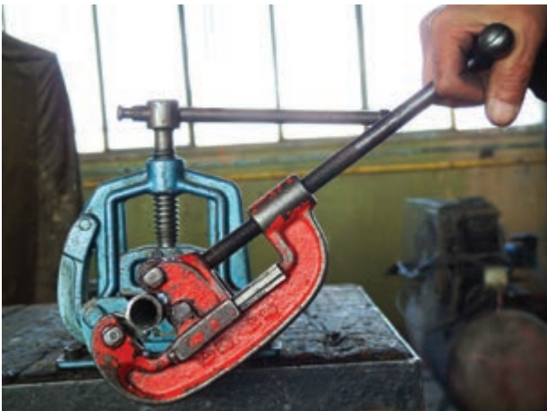
شکل ۱۵۰-۵- بریدن لوله ها
