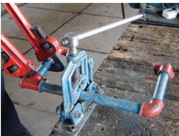
شکل ۵-۱۵۶- بستن ضلع سوم مدار به سه‌راهی
