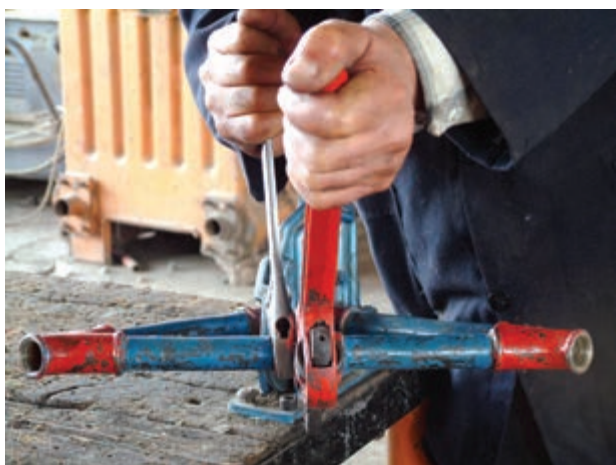
شکل ۱۴۴-۵- سفت کردن مهره ماسوره به وسیله ی دو عدد آچار
