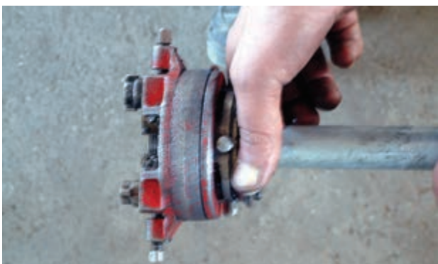
شکل ۱۲۴-۵- باز کردن فلکهای چهار نظام حدیده
