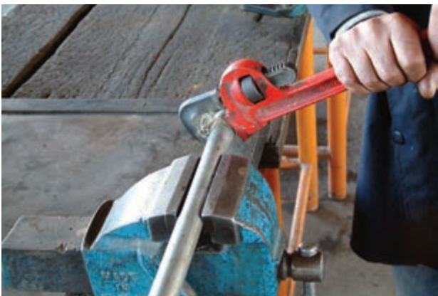
شکل ۵-۱۰۲- روش غلط نگهداری لوله به وسیله‌ی گیره‌ی لوله
