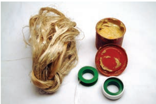
شکل ۴۸-۵- مواد آب‌بندی لوله‌کشی آب و فاضلاب
