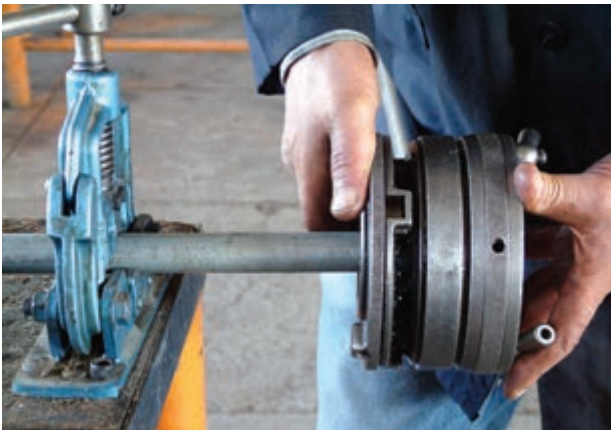
شکل ۱۳۰-۵- حدیده کردن لوله‌ها
