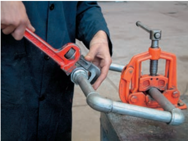
شکل ۵-۱۰۶- نحوه‌ی غلط سفت کردن مهره ماسوره
