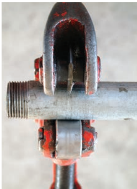
شکل ۹۶-۵- استفاده‌ی غلط از لوله‌بر با تیغه‌ی شکسته
