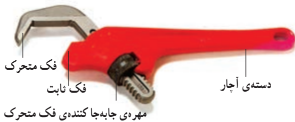
ب - آچار قابل تنظیم زاویه‌ای
