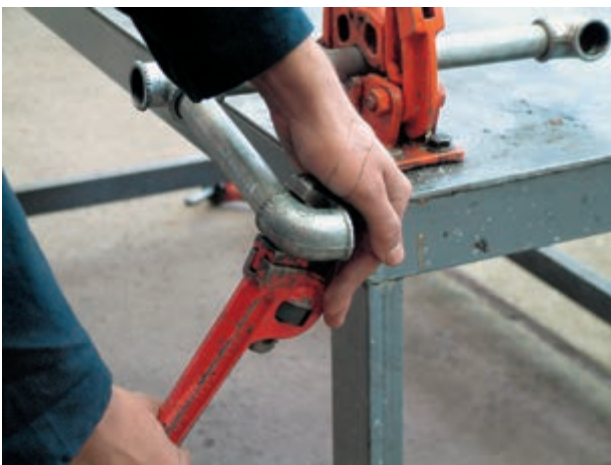
شکل ۱۰۵-۵- روش غلط سفت کردن مدار
