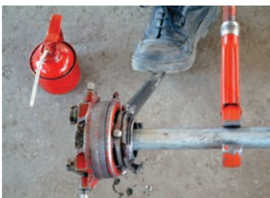
شکل ۱۲۳-۵- عمل باز کردن سردنده از پارچه‌های حدیده
