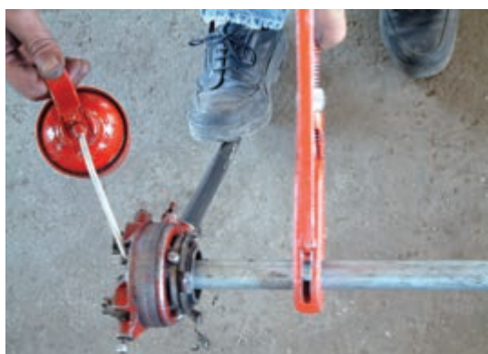
شکل ۱۲۱-۵- استفاده از روغن در جریان حدیده کاری
