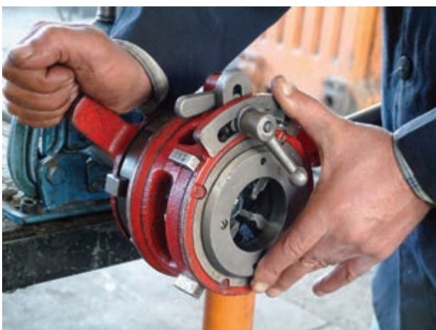
شکل ۴-۱۱۴- سفت کردن فلکه‌ی چهار نظام
