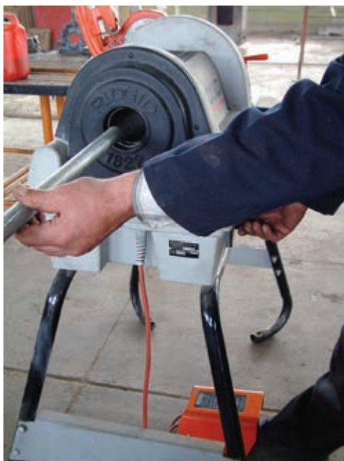
شکل ۱۳۱-۴- قراردادن لوله در حدیده‌ی ماشینی
