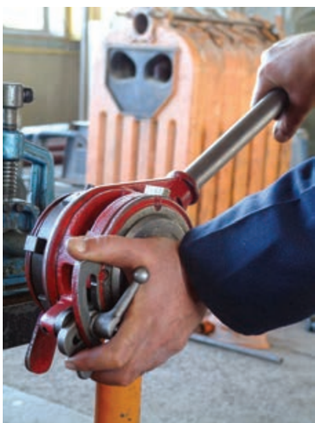
شکل ۴-۱۲۲- عمل درگیر کردن پارچه‌ها با سر لوله
