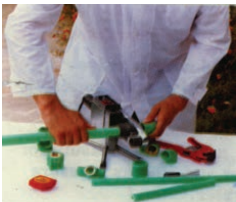
شکل ۲۸-۵- قراردادن لوله و فیتینگ به صورت هم‌زمان در درون دستگاه
