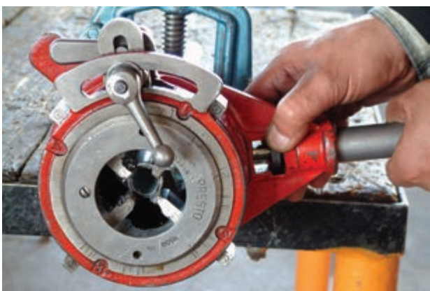
شکل ۴-۱۲۱- قرار دادن ضامن تغییر جهت دهنده‌ی حدیده در حالت حدیده کردن
