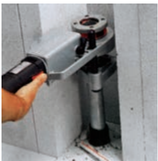
شکل ۴-۱۰۵ - طرز استفاده از حديدى
