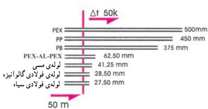
شکل ۲۱-۵- مقایسه‌ی انبساط طولی پلیمرها و فلزات
