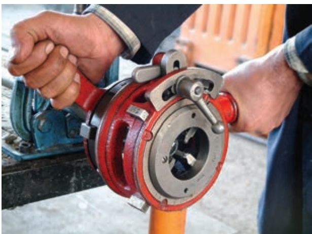
شکل ۴-۱۲۰- بستن اهرم فلکهای چهار نظام
