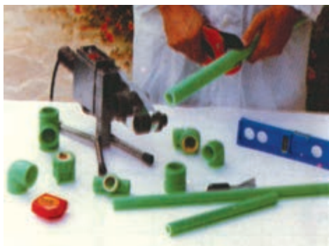
شکل ۲۷-۵ - بریدن لوله به وسیله‌ی قیچی مخصوص
