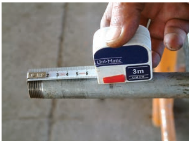
شکل ۱۲۸-۴- اندازه‌گیری لوله‌ی حدیده شده
