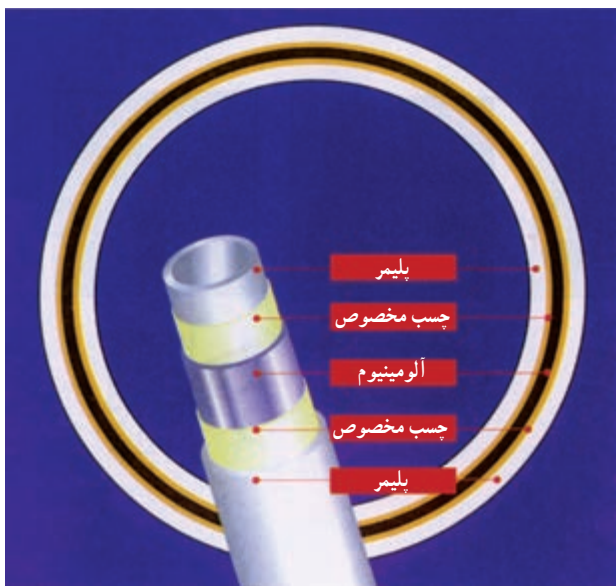
شکل ۲۰-۵- ساختار لوله‌ی پلی اتیلن پنج لایه
