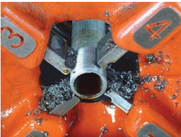
شکل ۴-۱۱۶ - طول مناسب دنده
