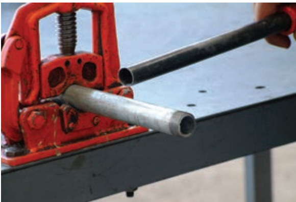
شکل ۴-۱۱۷ - جداسازی پلیسه از سر دنده
