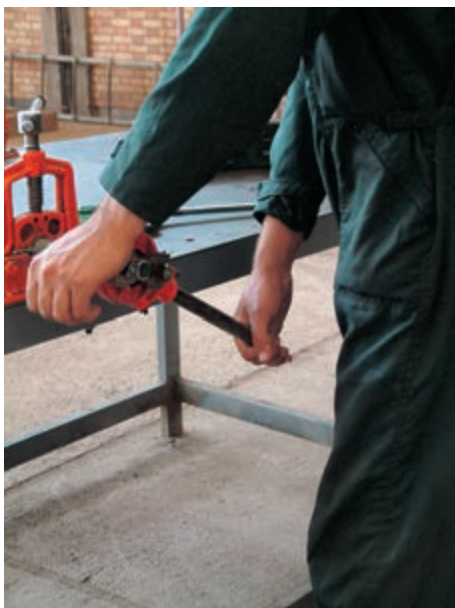
شکل ۴-۱۱۲- حدیده‌ی متناسب با قطر لوله
