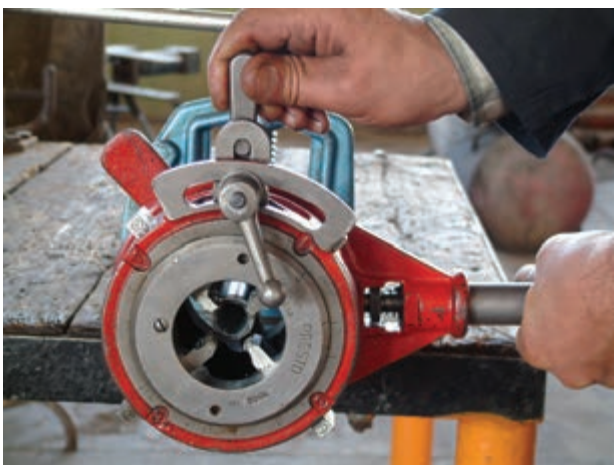
شکل ۱۲۵-۴- كم كردن بار پارچه‌هاي حديدك
