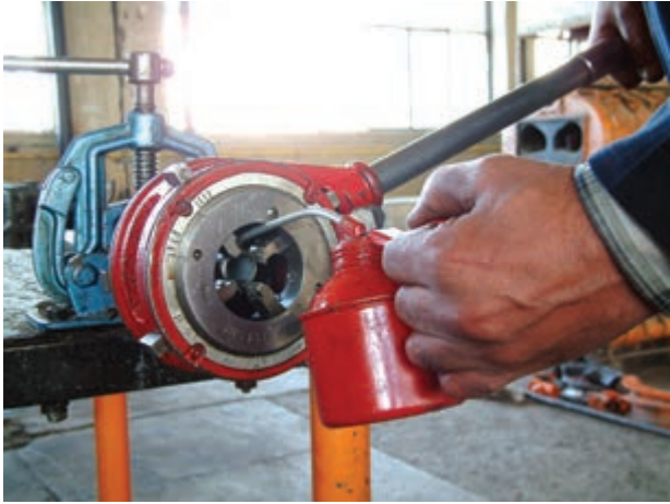
شکل ۱۲۳-۴- استفاده از روغن دان در جریان حديدكاري
