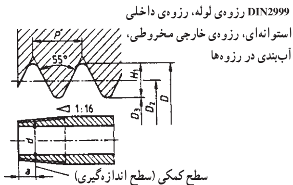
شکل ۴-۱۱۸ - مشخصات دنده‌ی لوله‌های گالوانیزه
