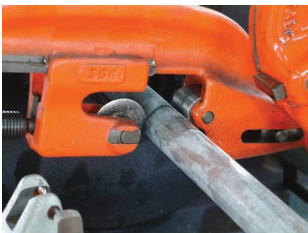
شکل ۴-۱۳۷- بریدن لوله به وسیله ی لوله بُر
