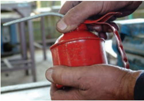
الف - باز کردن پمپ از مخزن روغن
