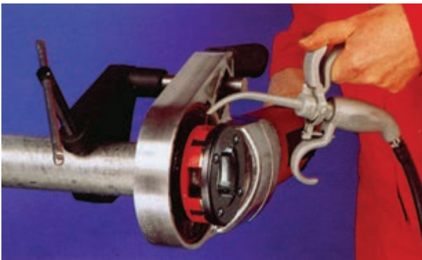
شکل ۴-۱۰۸- استفاده از روغن‌دان در جریان لوله‌کشی
