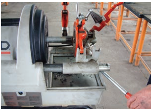
شکل ۴-۱۴۰- پایان عمل حدیده کاری
