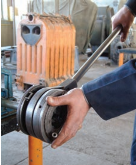
شکل ۴-۶۶- درگیر کردن حدیده با سر لوله
