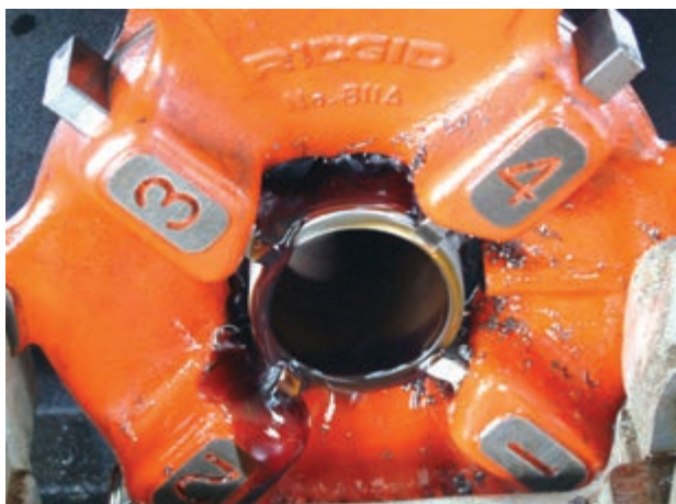
شکل ۴-۹۵- عمل حدیده‌کاری به وسیله حدیده‌ی ماشینی
