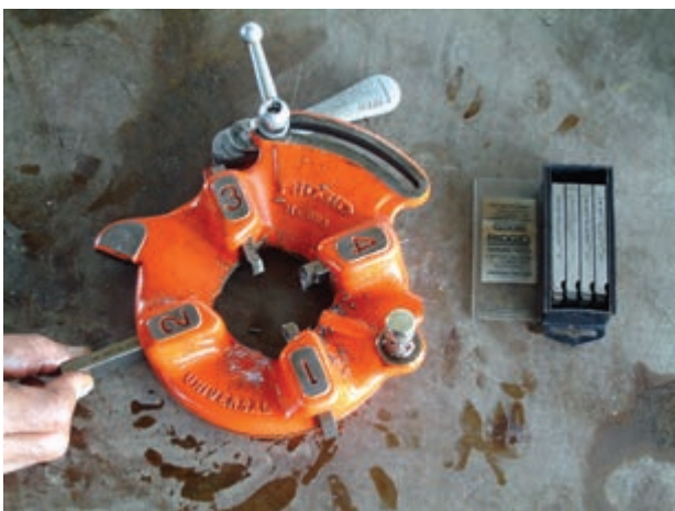
شکل ۴-۹۲- جا زدن پارچه‌ها در شیارهای تنه‌ی حدیده
