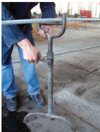
شکل ۴-۷۶- طرز تنظیم خرک به زیر لوله
