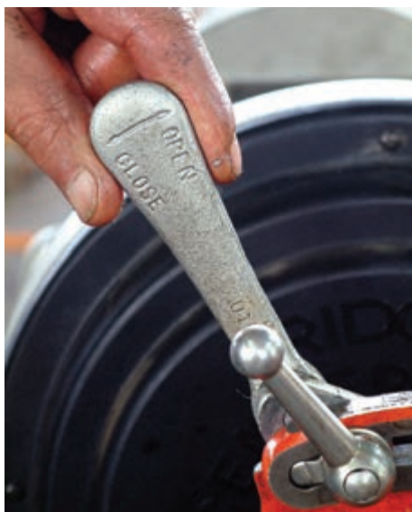
شکل ۴-۹۷- کشیدن ضامن تنظیم به عقب
