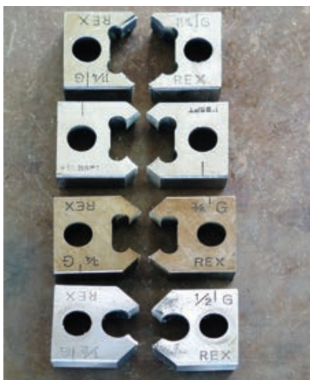
شکل ۴-۲۳- پارچه‌های حدیده‌ی دستی دو پارچه
