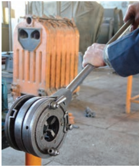
شکل ۴-۶۷- دنده کردن لوله
