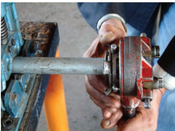
شکل ۴-۳۹- باز کردن فلکهای چهارنظام
