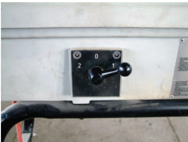
شکل ۴-۷۹- کلید خاموش و روشن کردن حدیده ی ماشینی
