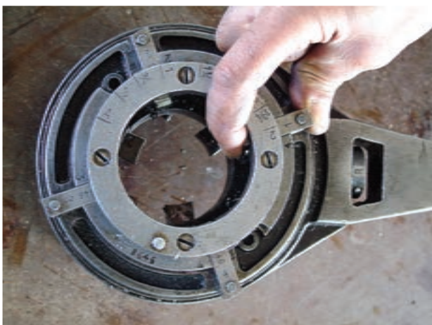
شکل ۴-۶۰- قرار دادن پارچه‌های مناسب در حدیده
