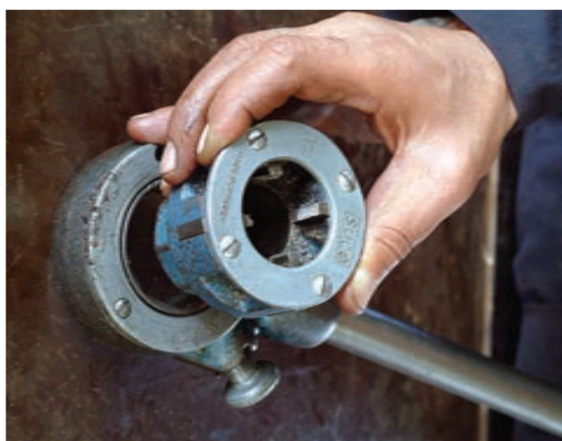
شکل ۴-۴۴- خارج کردن پارچه از بدنه‌ی حدیده
