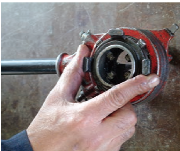
شکل ۴-۲۱- فلکه‌ی چهار نظام حدیده‌ی دستی دو پارچه
