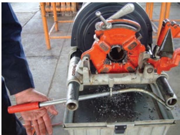
شکل ۴-۹۸- کشیدن اهرم به عقب پس از حدیده‌کاری
