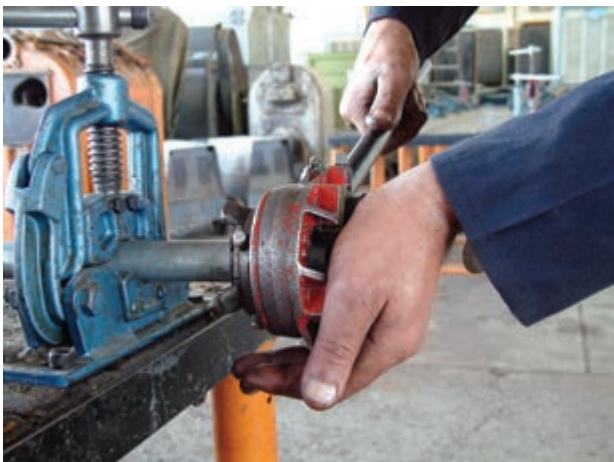
شکل ۳۳-۴- درگیر نمودن پارچه‌های حدیده با لوله
