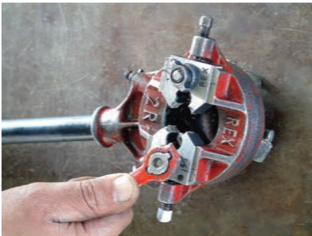
شکل ۴-۲۸ - سفت کردن مهره به وسیله‌ی آچار حدیده
