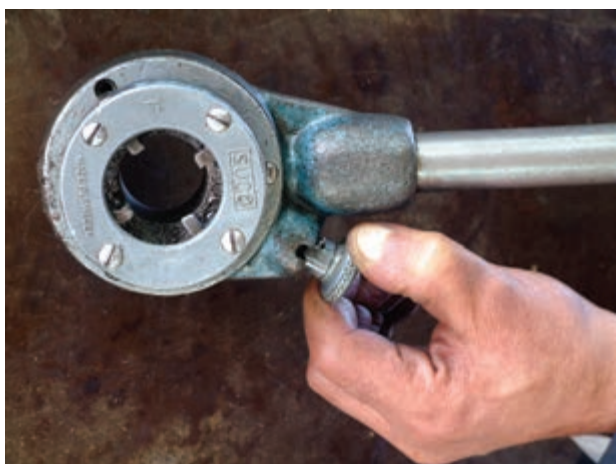
شکل ۴-۴۳- خارج کردن ضامن از شیار
