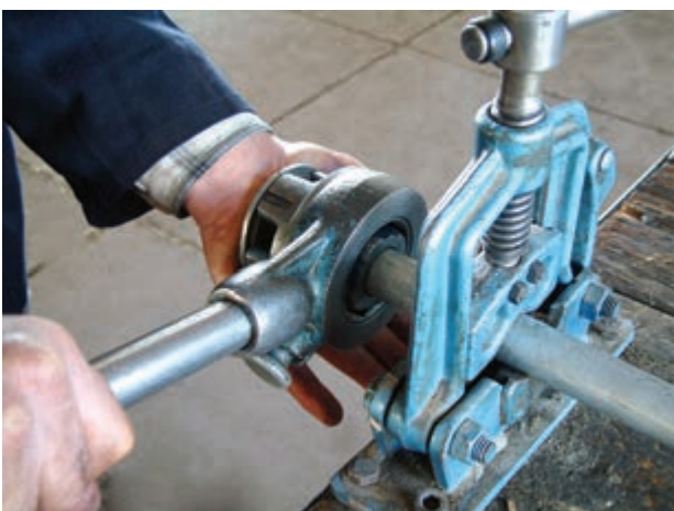
شکل ۴-۴۷- شروع دنده کردن لوله
