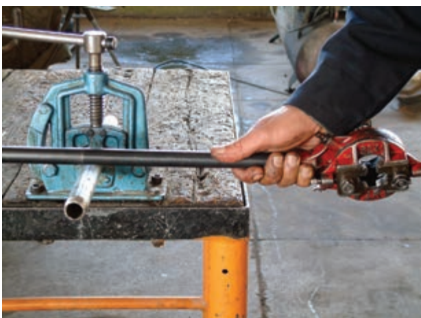
شکل ۴-۴۰- جدا کردن پلیسه‌ها از سردنده
