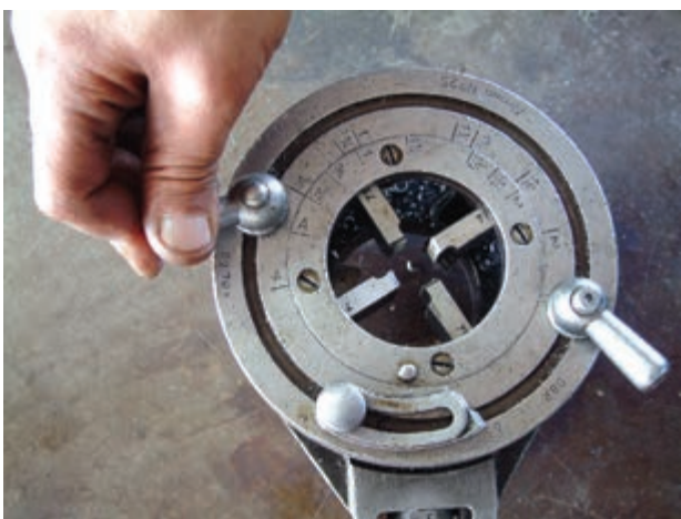
شکل ۴-۶۲- سفت کردن مهره‌های ثابت‌کننده‌ی رینگ متحرک
