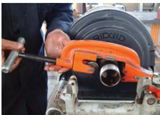
شکل ۴-۱۰۱- بریدن لوله به وسیله‌ی لوله‌بُر
