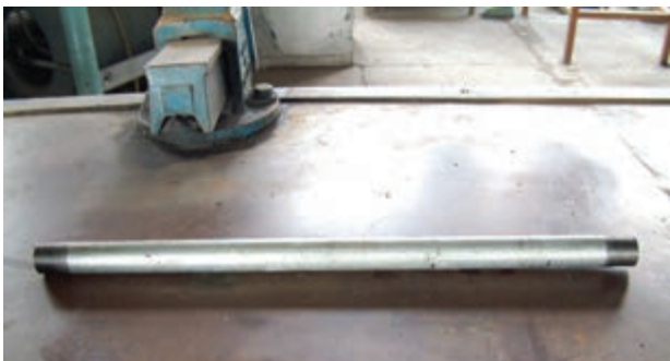
شکل ۴-۶- لوله ی دو سر دنده شده
