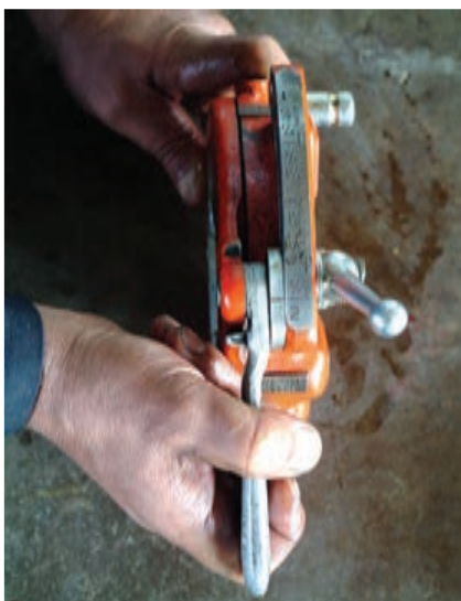
شکل ۴-۹۳- تنظیم حدیده به اندازه‌ی لوله‌ی ۲ اینچ
