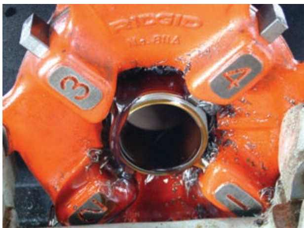
شکل ۴-۸۲- استفاده از روغن در موقع حدیده‌کاری
