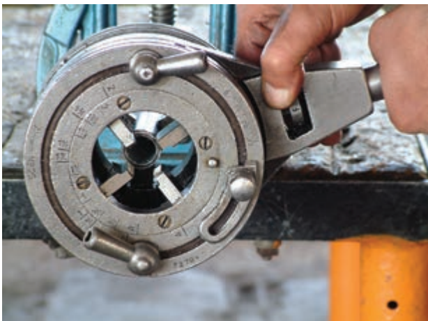
شکل ۴-۵۶- قرار دادن ضامن در حالت F
