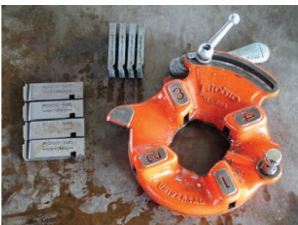
شکل ۸۹-۴- مشخصات حک شده بر روی پارچه‌های حدیده
