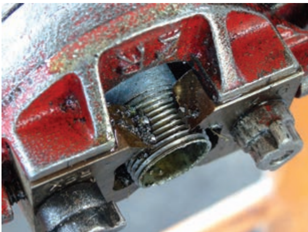
شکل ۴-۳۶- عبور دو دندانه از انتهای پارچه
