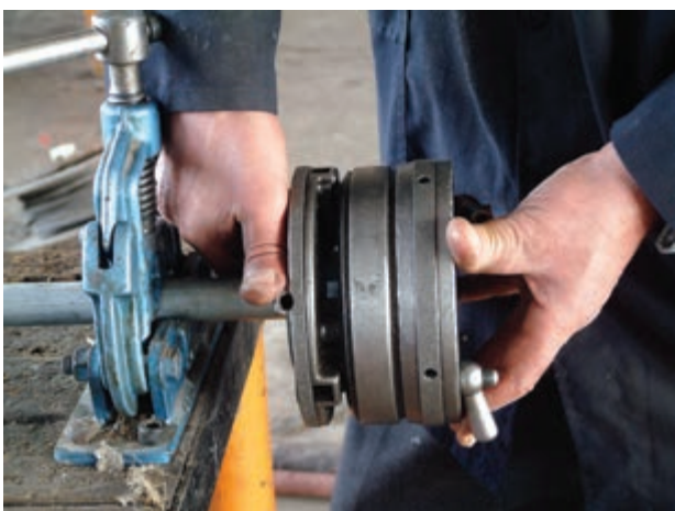
شکل ۴-۶۴- سفت کردن سه نظام حدیده
