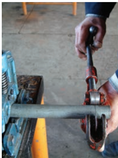
شکل ۴-۷۷- لوله‌بُر در حال گردش به دور لوله
