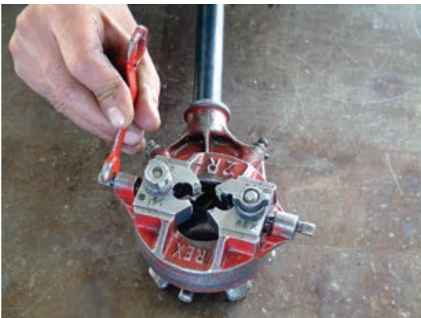
شکل ۴-۲۹ - تنظیم کردن حدیده به وسیله‌ی آچار حدیده
