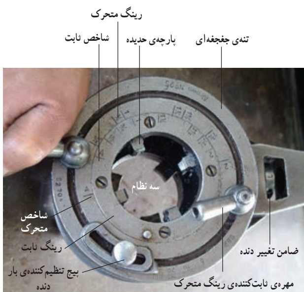
شکل ۴-۵۵- اجزای حدیده‌ی دستی چهار پارچه
