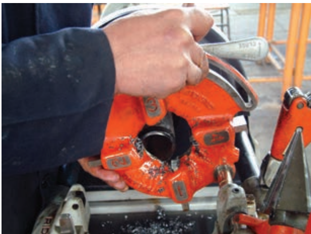
شکل ۴-۹۰- جدا کردن تنه‌ی حدیده از دستگاه
