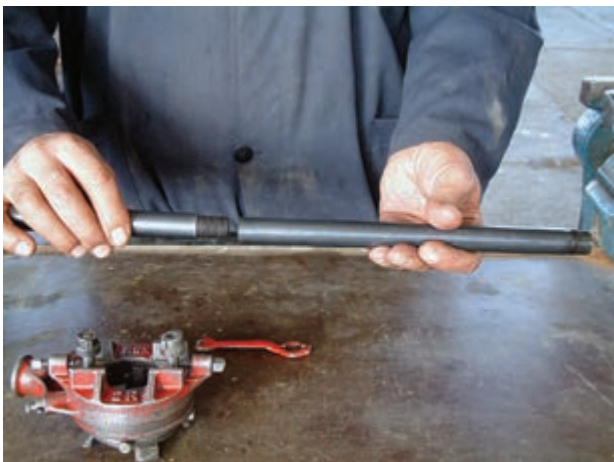
شکل ۴-۲۴ اتصال دسته‌ی دو تکه به یک‌دیگر
