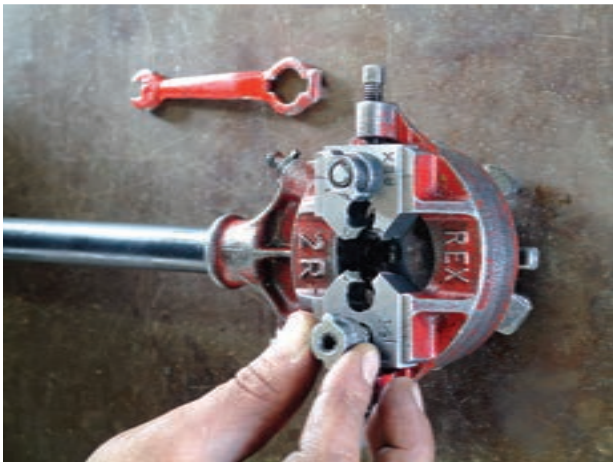
شکل ۴-۲۷ - بستن مهره‌ها بر روی پارچه‌های حدیده
