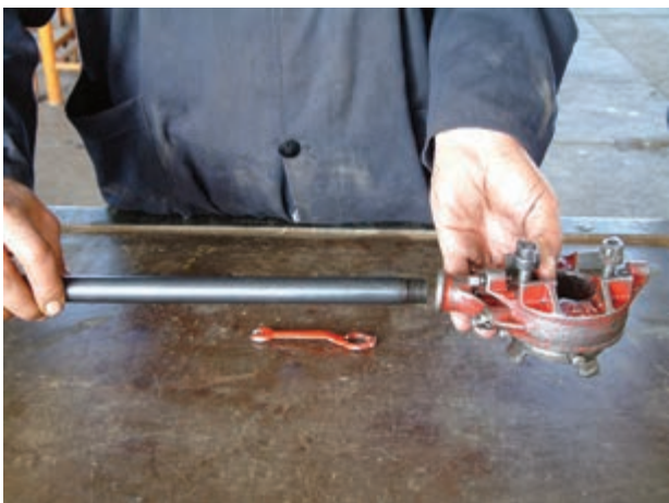
شکل ۴-۲۵ اتصال دسته‌ی حدیده به بدنه‌ی حدیده
