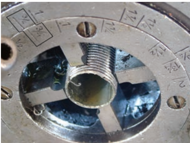
شکل ۴-۶۹- حد صحیح حدیدیه کردن لوله‌ی \frac{3}{4}
