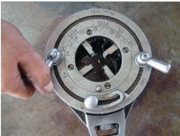
شکل ۴-۵۷- قرار گرفتن ضامن در حالت F و شل کردن مهره‌های ثابت کننده‌ی رینگ متحرک
