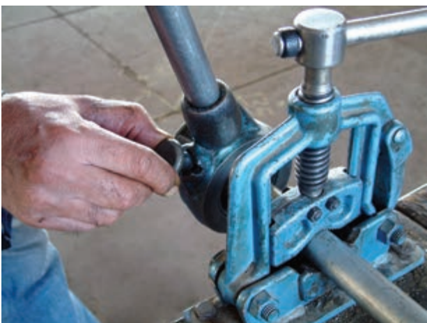
شکل ۴-۴۶- قرار دادن ضامن در جهت حدیده کردن
