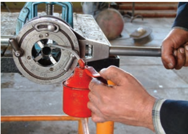
شکل ۴-۶۸- عمل روغن کاری در حین حدیده کاری
