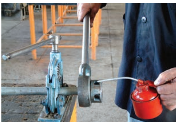
شکل ۴-۴۹- روغن کاری محل تماس پارچه‌ها با لوله
