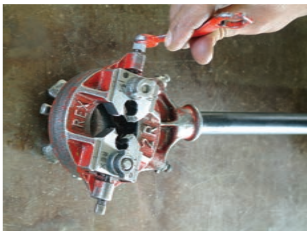
شکل ۲۰-۴- اجزای حدیده‌ی دستی دو پارچه
