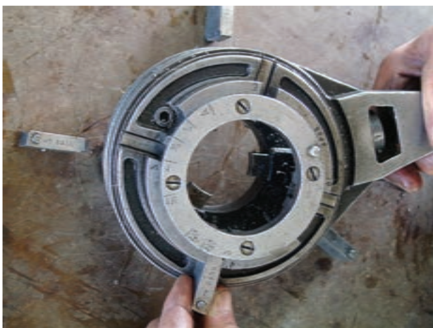
شکل ۴-۵۹- خارج کردن پارچه‌ها از حدیده
