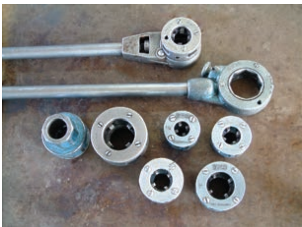
شکل ۴-۴۲- حدیده‌ی چهارپارچه‌ی غیر قابل تنظیم
