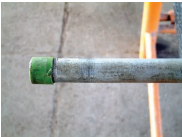
شکل ۱۶-۴ اتصال بوشن پلاستیکی به سردنده‌ی لوله
