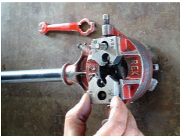
شکل ۴-۲۶ قرار دادن پارچه‌ها در محل خود
