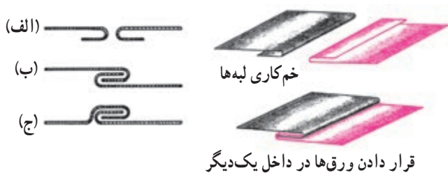
شکل ۴-۲- مراحل مختلف اتصال پیچک
