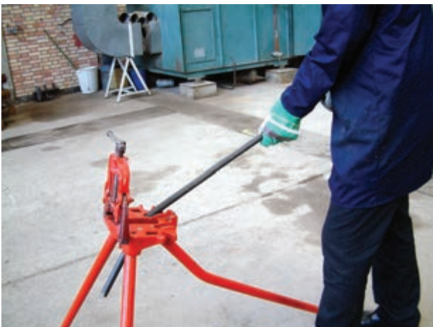
شکل ۳-۹- خم کاری لوله به وسیله‌ی گیره‌ی صحرایی
