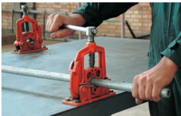
شکل ۳-۵۳- باز کردن شاخه‌ی لوله از گیره‌ی لوله
