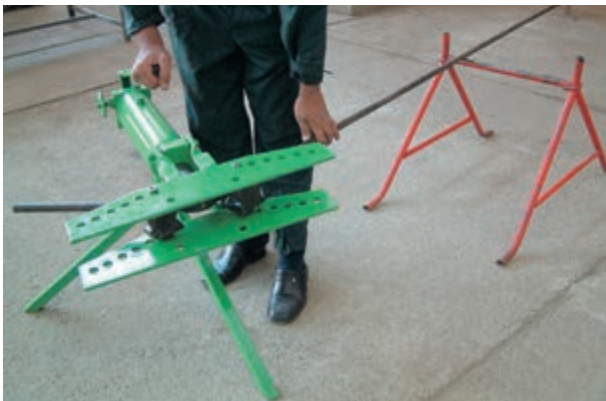
شکل ۳-۴۲- استفاده از خرک در خم‌کاری
