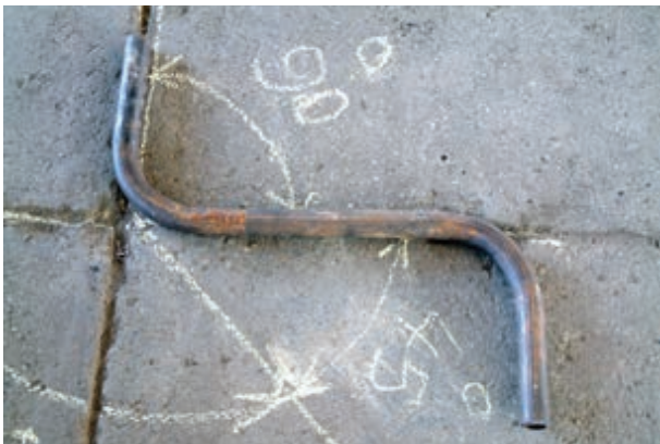
شکل ۳-۴۱- عدم دویدگی لوله‌ی دو خم
