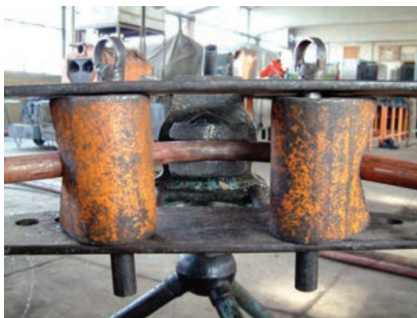
الف- باز کردن خم لوله‌ی خم شده
