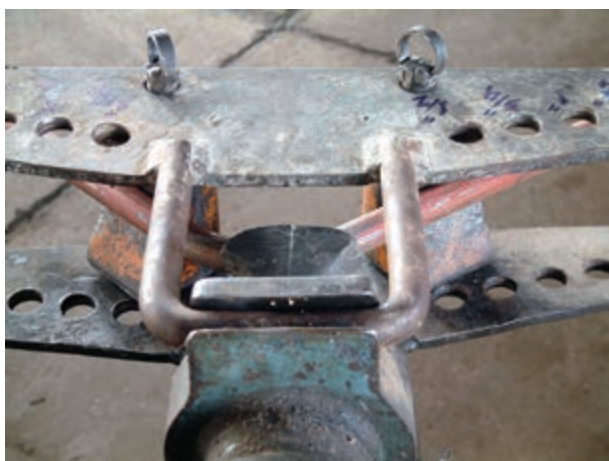
ب- باز کردن خم لوله‌ی خم شده
