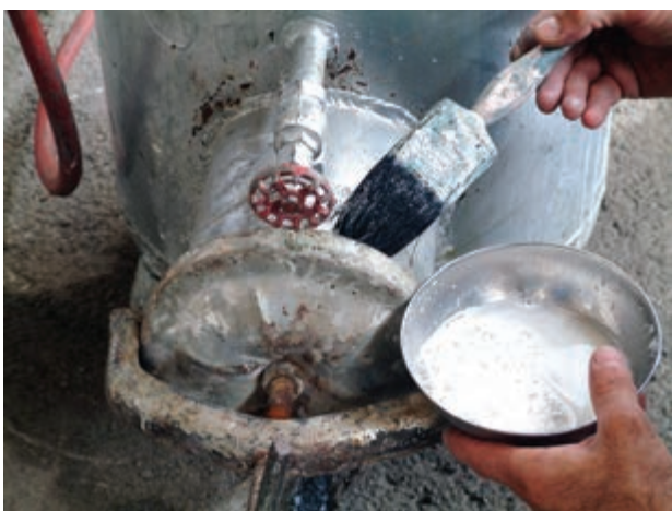
شکل ۲-۳۹- کنترل نشستی گاز
