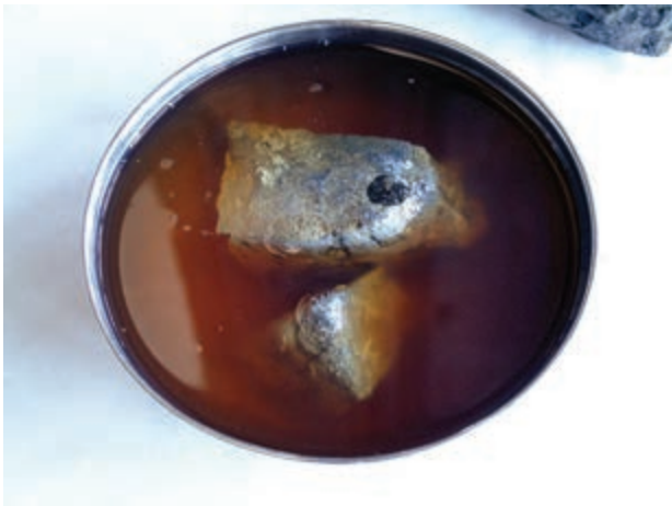
شکل ۱۲-۲ نگهداری کاربید در زیر نفت
