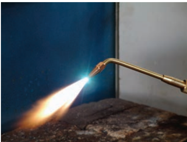
شکل ۲-۳- شعله‌ی سوختن گاز استیلن با اکسیژن
