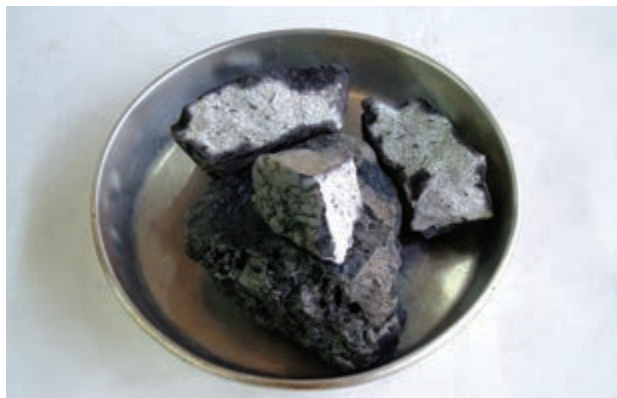
شکل ۲-۱۱- مقطع شکسته شده‌ی سنگ کاربید و شکل ظاهری آن
