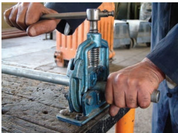
شکل ۳۵-۱- بستن لوله به گیره برای ارّه‌کاری
