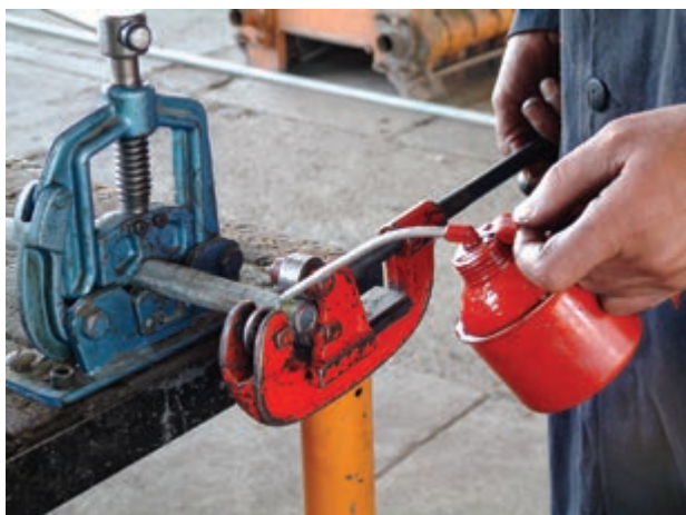
شکل ۱-۵۷ - ریختن روغن در محل تماس
