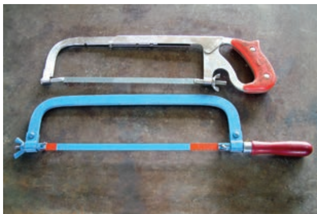
شکل ۱-۵- کمان اژه‌ی ثابت با دسته‌ی معمولی و متغیر با دسته‌ی هفت تیری
