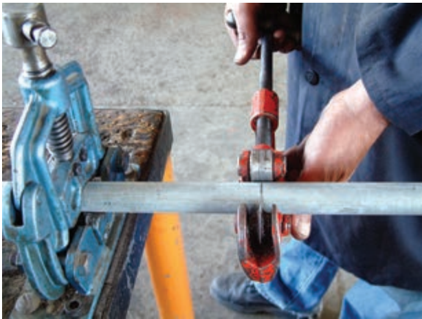
شکل ۱-۶۲- سفت کردن دسته‌ی لوله‌بر به اندازه‌ی لازم
