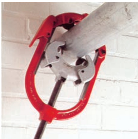
شکل ۱-۲۳- لوله‌بر دستی چهار تیغه
