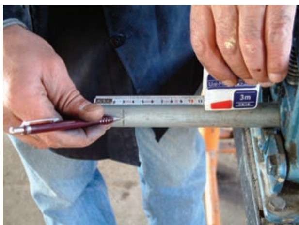
شکل ۷-۱- علامت‌گذاری کردن لوله با متر و مداد
