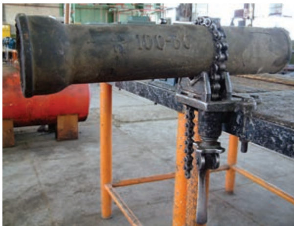
شکل ۱-۳۴- بستن لوله به گیره‌ی زنجیری
