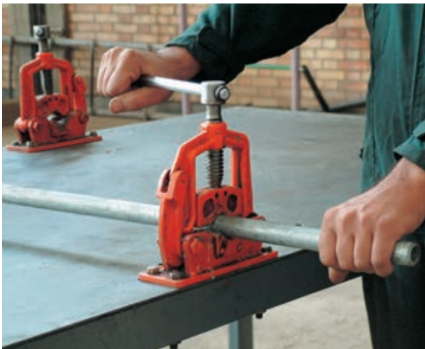
شکل ۱-۲۸- بستن لوله به گیره‌ی لوله
