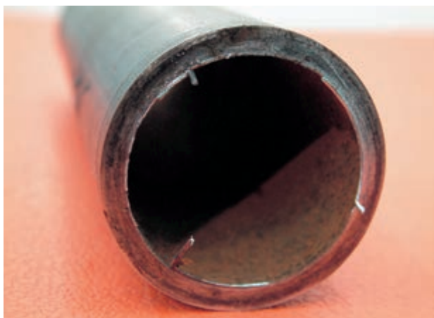
الف - لوله‌ی بریده شده به وسیله‌ی لوله‌بر
