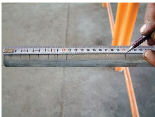
شکل ۱-۶۴- خط کشی کردن لوله
