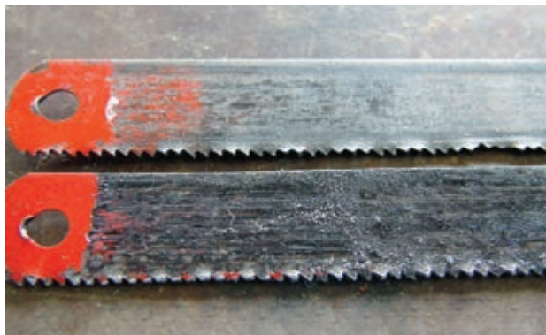
شکل ۱-۴۷- تیغه اره‌های دندان‌های شکسته شده
