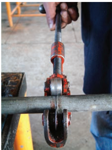
شکل ۱-۵۵ - بریدن لوله
