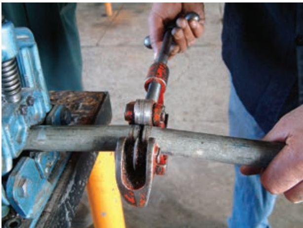
شکل ۱-۵۹- انتهای عمل بُرش‌کاری
