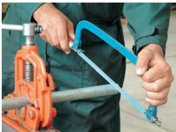
شکل ۵۰-۱- عدم رعایت فاصله‌ی مناسب از لب گیره
