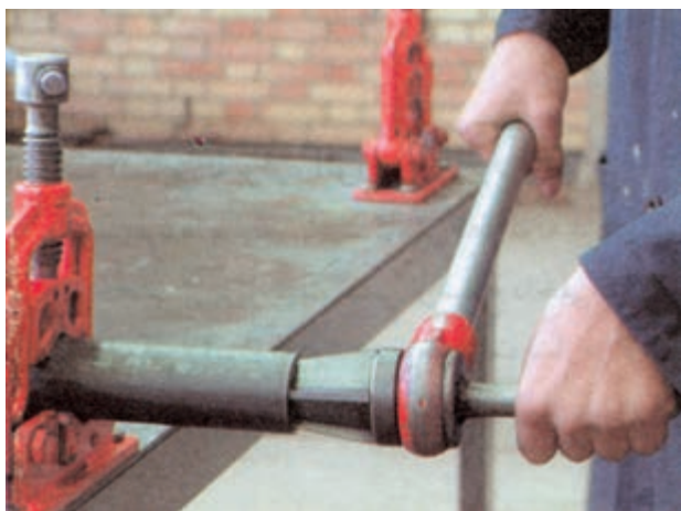
شکل ۲-۱۲- عمل بُرقوکاری
