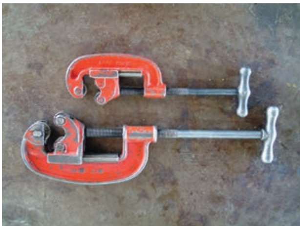
شکل ۱-۶۳- لوله‌بر در دو اندازه‌ی متفاوت
