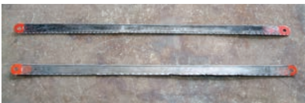
شکل ۱-۴۰ - از بین رفتن دندان‌های تیغه اژه
