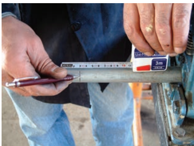
شکل ۱-۵۳ - مشخص کردن محل برش
