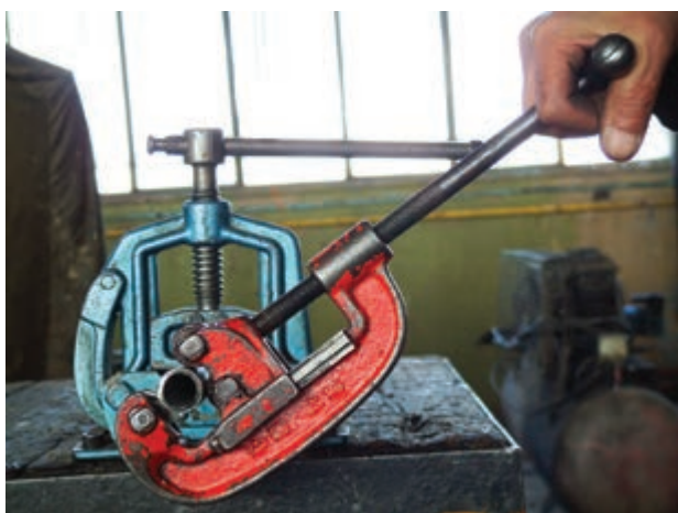
شکل ۱-۵۶ - گرداندن لوله‌بُر به دور لوله
