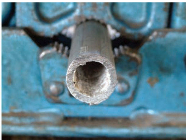
شکل ۱-۵۲ - لوله‌ی بسته شده به گیره‌ی لوله
