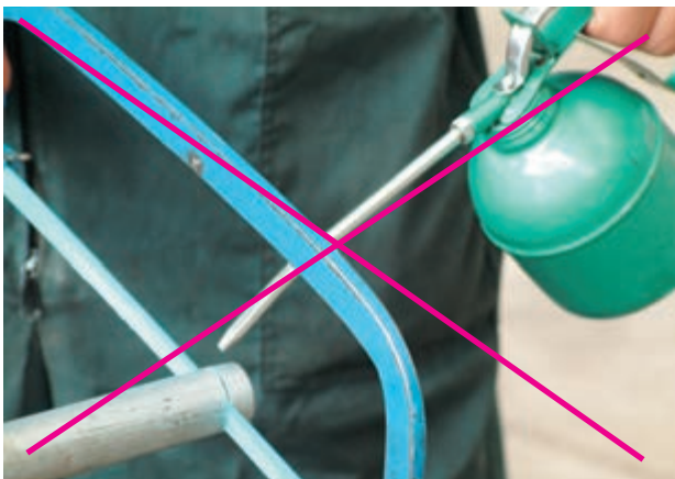
شکل ۱-۴۲ - هیچ‌گاه از روغن در اژه کاری استفاده نکنید.
