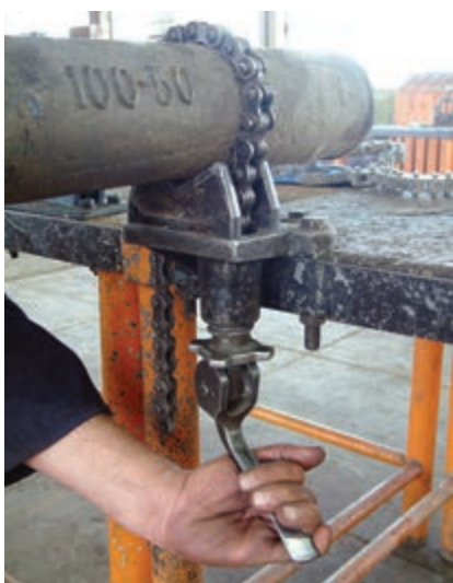
شکل ۱-۳۳- کشیدن اهرم قفل کننده
