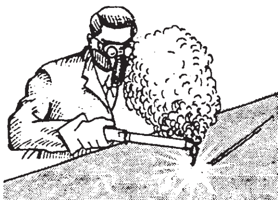
شکل ۱-۳۰- در موقع برشکاری روی سطوح گالوانیزه و رنگ شده از ماسک تنفسی استفاده کنید.
