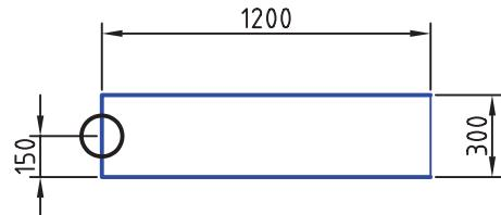
۵. با استفاده از دستور Extrude با عملکرد Join پروفایل را به اندازه‌ی ۳۰ میلی‌متر به سمت بالا برجسته کنید.
