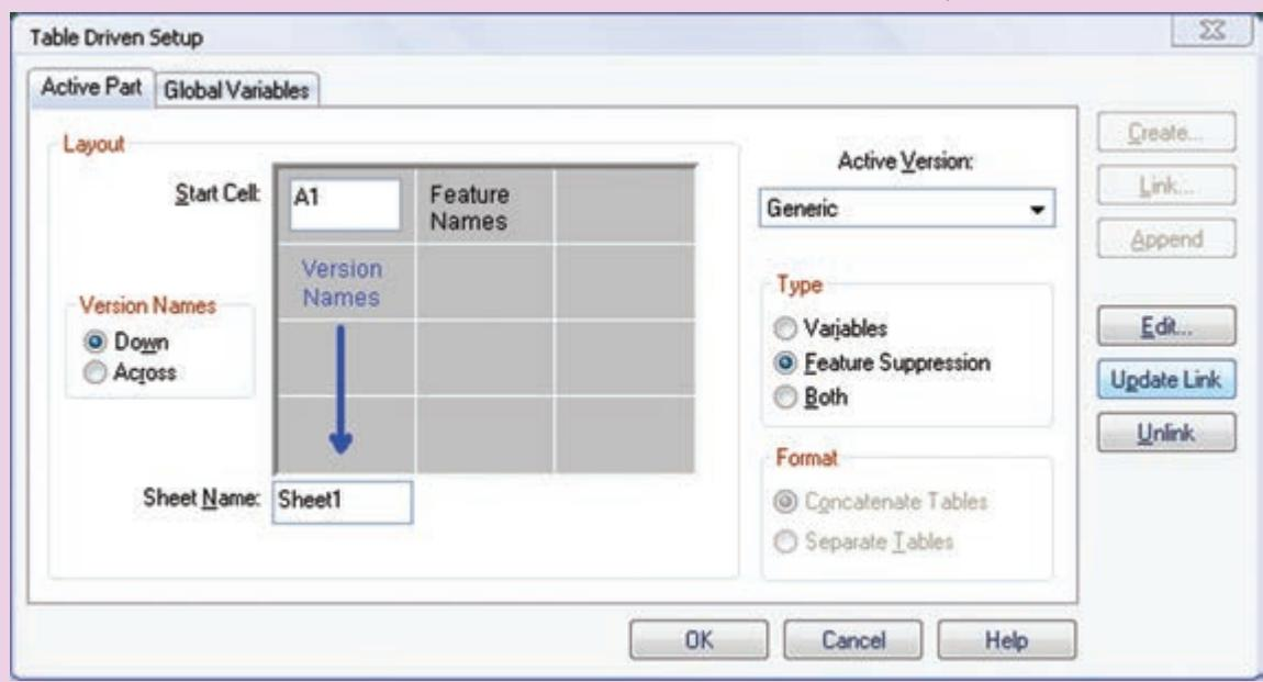
نمایه‌های Suppress شده در مرورگر دسکتاپ از Unsuppress By و Unsuppress Feature دستورهای در منوی Part >> Feature Suppression type می‌توانیم استفاده کنیم.
