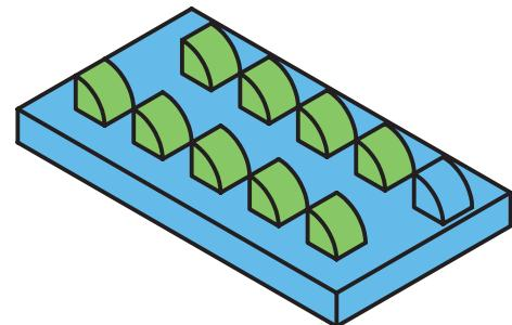
یکی از انواع آرایه‌های مورد استفاده در مکانیکال دسکتاب آرایه‌ی ماتریسی یا سطري - ستونی است که با استفاده از گزینه‌ی Rectangular Pattern در دستور AMPATTERN قابل دسترس است. با استفاده از این دستور به انواع دیگر آرایه‌ها نیز دسترسی خواهیم داشت.
