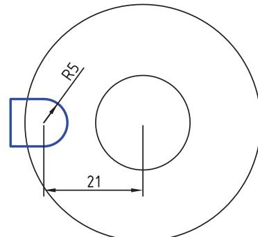
٤. با استفاده از کلید میانبر ۸۸ به نمای ایزومتریک بروید و با استفاده از دستور Extrude Cut پروفایل را ۲ میلی‌متر به سمت پایین فرورفته کنید.
