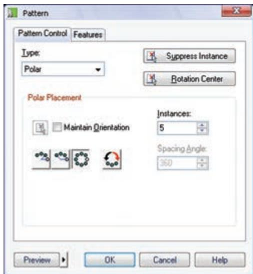
١٠. پنجره‌ی Pattern را OK نمایید و با استفاده از آیکن Toggle Shading/Wireframe در نوار ابزار Mechanical View مدل را در حالت سایه‌پردازی مشاهده کنید.
