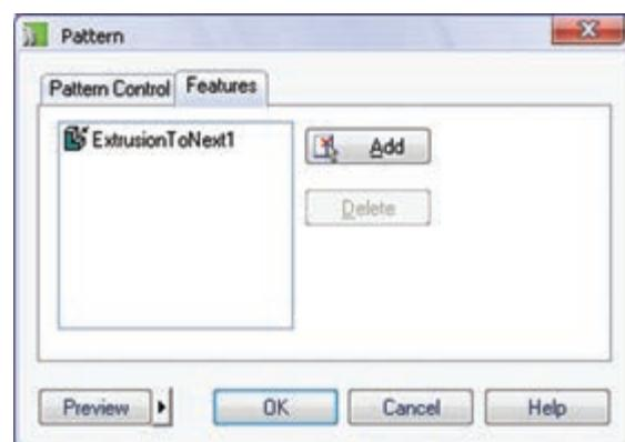
در شکل زیر آرایه‌ی ایجادشده در قطعه‌ی بالا بدون تیک زدن گزینه‌ی Maintain Orientation است در حالی که در قطعه‌ی پایین این گزینه تیک خورده است و نقطه‌ی کاری نشان داده شده در نمایه ثابت باقی مانده است.
