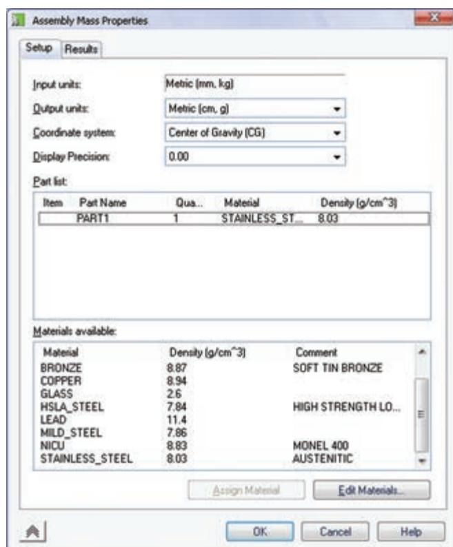
برای اختصاص دادن یک متریال به یک قطعه ابتدا آن قطعه را در فهرست قطعات انتخاب می کنیم و از بخش Materials Available متریال مورد نظر را برای آن انتخاب می کنیم. سپس دکمه Assign Material را کلیک می کنیم.
