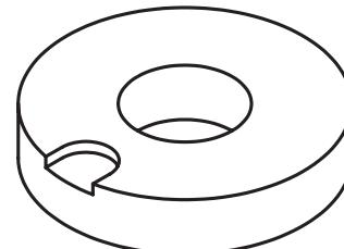
٥. در مرکز کمان R5 یک دایره به قطر ۵ میلی‌متر ترسیم و آن را به پروفایل تبدیل کنید. با استفاده از دستور Extrude Cut پروفایل را با حالت پایان‌دهی Through Hole نیز می‌توانید برای این سوراخ استفاده کنید. (از دستور
