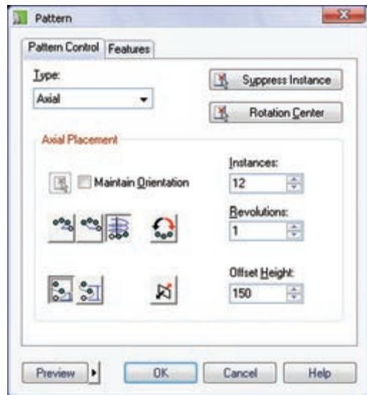
۹. پنجره‌ی Pattern را OK نمایید و با استفاده از آیکن Toggle Shading/Wireframe در نوار ابزار آیکن Mechanical View مدل را در حالت سایه‌پردازی مشاهده کنید.
