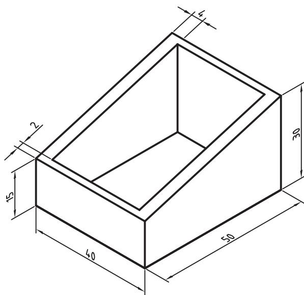
۸. قطعه‌ی زیر را بعد از مدل‌سازی با استفاده از دستور Face Draft با مشخصات نشان‌داده شده شبیدار کنید. (۳۰ دقیقه)
