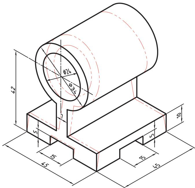
۷. مدل زیر را با استفاده از دستور Shell و با ضخامت‌های نشان داده شده توانایی کنید. (۳۰ دقیقه)
