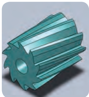
تیغه فرز دارای لبه‌های برنده مارپیچ
