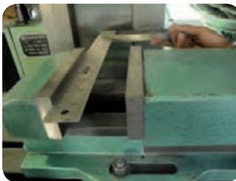
تنظیم فک‌های گیره با استفاده از گونیا
