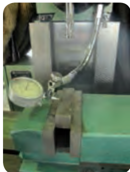
استفاده از بلوک‌های گونیایی برای کنترل فک‌های گیره
