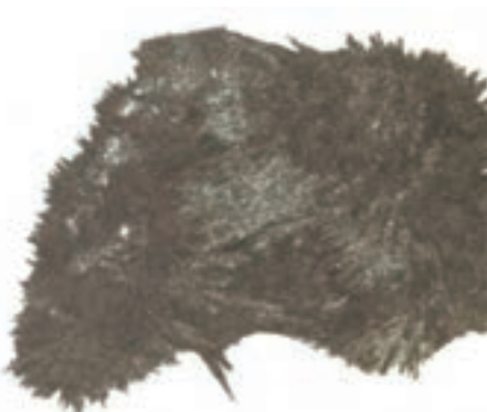
شکل ۷-۳- سنگ آهن طبیعی که براده های آهن به آن چسبیده است.
