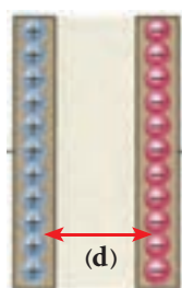
شکل ۸-۳- میدان الکتریکی موجود بین دو صفحه
