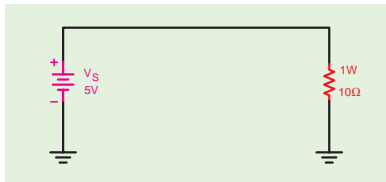
شکل ۱۶-۶ بررسی جریان مصرف کننده براساس توان مجاز
